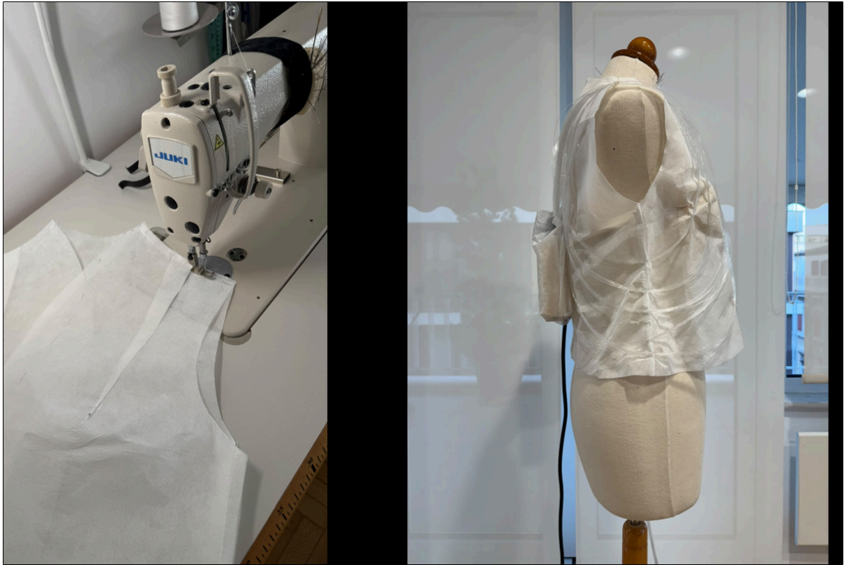
Εικόνα 41. Ράψιμο πρώτου επιπέδου σωσιβίου
