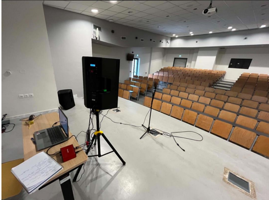
Σχήμα 6.6 : Θέση μέτρησης συχνотικής απόκρισης ηχείου
