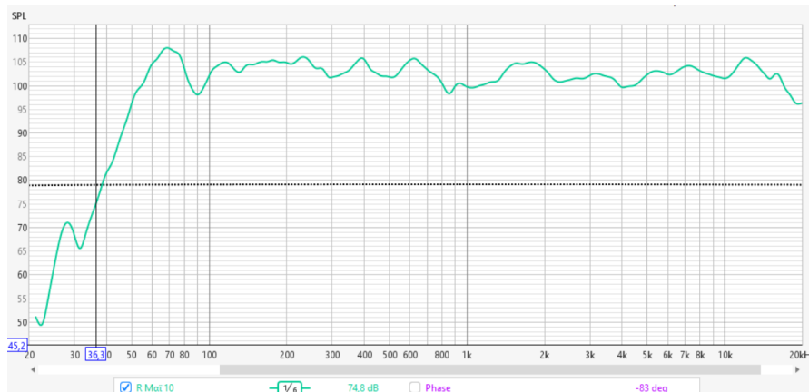
Σχήμα 6.5 : Απόκριση συχνότητας ηχείο LD Iqoa 12a στο 1 μέτρο
