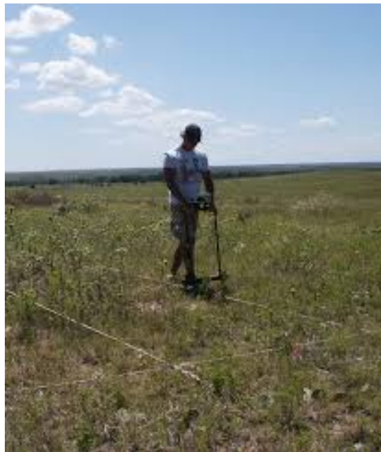
Εικόνα 2: Ηλεκτρική αντίσταση στο πεδίο.
