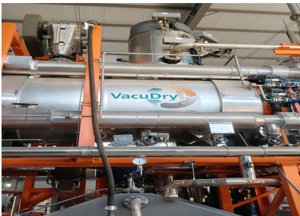
Εικόνα 10. Περιστροφικός αντιδραστήρας ο οποίος περιβάλλεται με το θερμικό έλαιο όπου μεταφέρει την επιθυμητή θερμοκρασία μέσα στον εξατμιστήρα.
