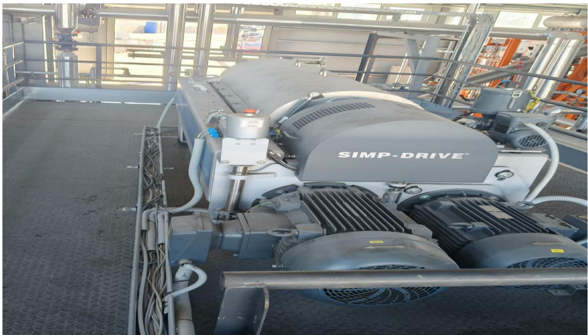
Εικόνα 5. Φυγοκεντρικός διαχωριστής, εξοπλισμένο με σύστημα κίνησης SIMP συνεχούς και αυτόματης προσαρμογής της διαφορικής ταχύτητας.
