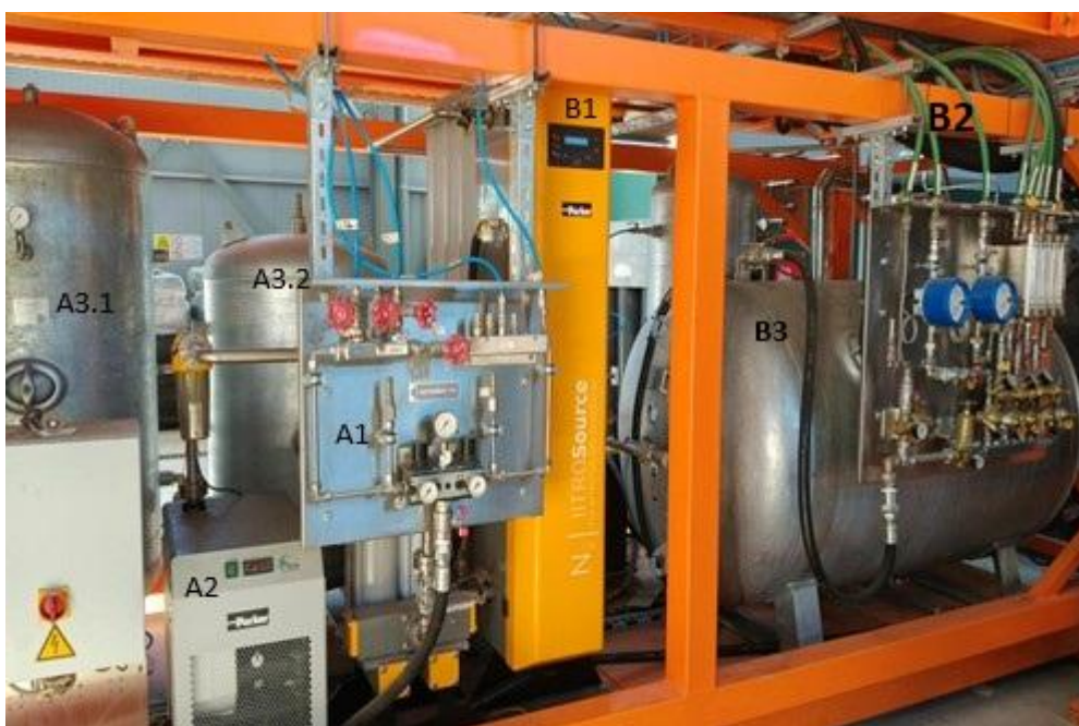
Εικόνα 13. Α (αριστερά πάνελ αέρα (A1), ο ξηραντήρας (A2), οι δεξαμενές προπίεσης του συστήματος για κάθε module (A3.1 και A3.2) . Β (δεξιά η παραγωγή αζώτου (B1), το πάνελ αζώτου (B2) και οι δεξαμενές αζώτου (B3).
