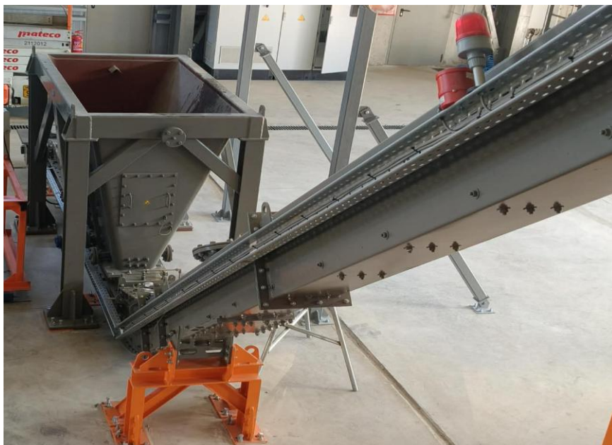
Εικόνα 14. Τροφοδοσία και μεταφορά εισερχομένης λάσπης.
