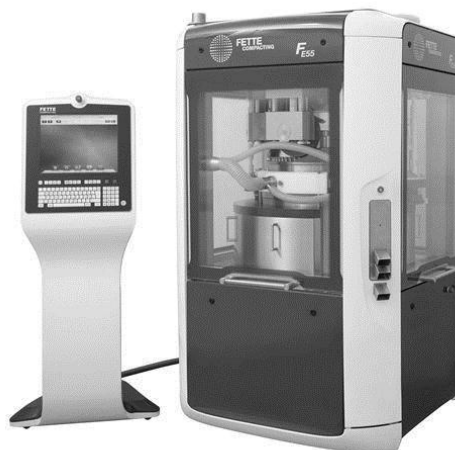
Εικόνα 3.6 Χαρακτηριστικό παράδειγμα περιστροφικής δισκιοποιητικής μηχανής (Fette) (Ρέκκας και Πολίτης, 2022)
