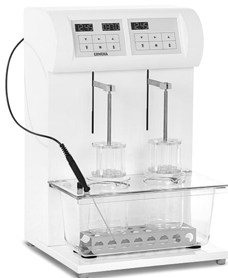
Εικόνα 3.12 Συσκευή αποσάθρωσης (Erweka) (Ρέκκας και Πολίτης, 2022)
