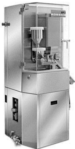
Εικόνα 3.5 Χαρακτηριστικό παράδειγμα έκκεντρης δισκιοποιητικής μηχανής (Korsch) (Ρέκκας και Πολίτης, 2022)
