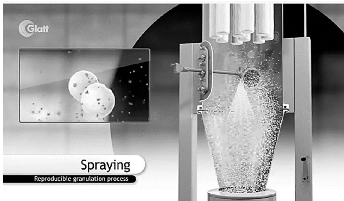
Εικόνα 3.3 Η λειτουργία της διάταξης ρευστής κλίνης με ψεκασμό (Ρέκκας και Πολίτης, 2022)
