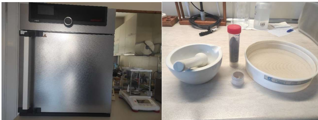
Εικόνα 7-1 Φούρνος ξήρανσης, πορσελάνινα γουδί και γουδοχέρι, κόσκινο 500 \mu\text{m} , περιέκτης πολυπροπυλενίου (PP) έτοιμου δείγματος και συναρμολογημένος δειματοφορέας
