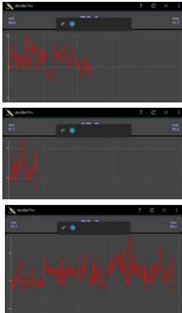
Εικόνα 33 (α, β, γ από επάνω προς τα κάτω) : Μετρήσεις ηχητικής στάθμης επί της προσόψεως σε διαφορετικές χρονικές στιγμές κατά την πραγματοποίηση μουσικών δραστηριοτήτων εντός του κτηρίου. Ο οριζόντιος άξονας αναφέρεται στη χρονική διάρκεια της μέτρησης σε λεπτά (min).
