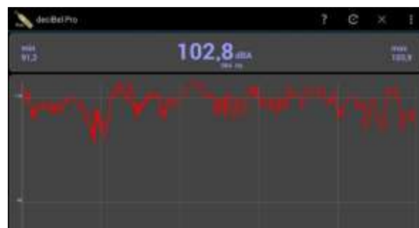
Εικόνα 37 : Μέτρηση ηχητικής στάθμης στο χώρο στην αίθουσα χορού 3, σε απόσταση 3μέτρων από το αριστερά ηχείο.
