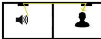
Εικόνα 5 : Απεικόνιση τρόπου μετάδοσης θορύβου μέσα από αεραγωγούς.
