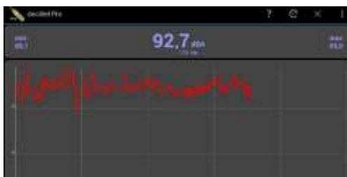
Εικόνα 34: Μέτρηση ηχητικής στάθμης στην αίθουσα χορού 1.
