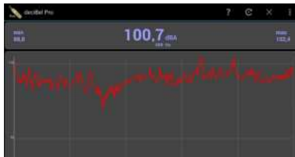
Εικόνα 39 : Μέτρηση ηχητικής στάθμης στο χώρο της αίθουσας χορού 3, σε απόσταση 5μέτρων από το κέντρο των ηχείων.
