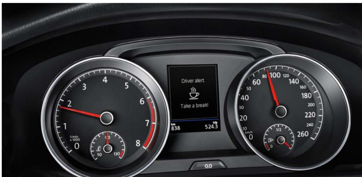
Εικόνα 26 Το Rest Assist ενημερώνει τον οδηγό ότι πρέπει να κάνει ένα διάλειμμα όταν ανιχνευθεί η κόπωση
