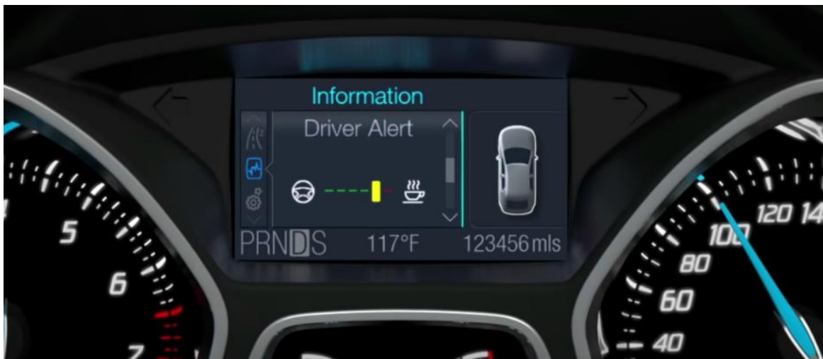
Εικόνα 24 Ford Alert System : Προειδοποιητικό μήνυμα ότι ο οδηγός πλησιάζει σε περιοχή όπου μπορεί να κάνει στάση για ξεκούραση.
