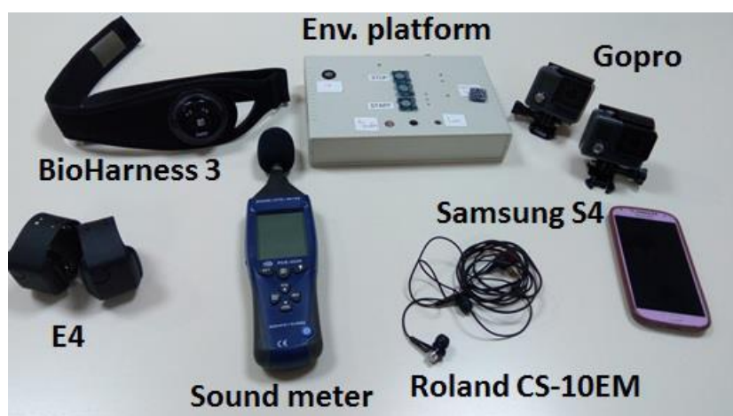
Εικόνα 3 Το δίκτυο αισθητήρων για την πλατφόρμα AffectiveRoad
