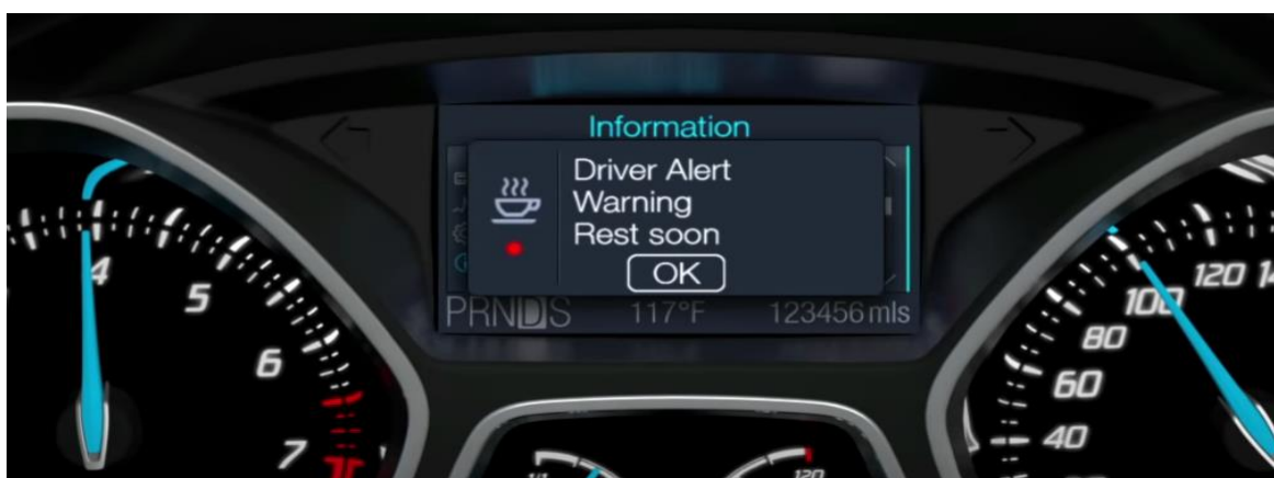
Εικόνα 23 Ford Alert System : Προειδοποιητικό μήνυμα κατά την ανίχνευση κόπωσης του οδηγού, σε περίπτωση που ο οδηγός έχει αγνοήσει το πρώτο προειδοποιητικό μήνυμα.
