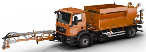
Σχήμα 4. Αυτοκινούμενο μηχάνημα (Road Patcher).
