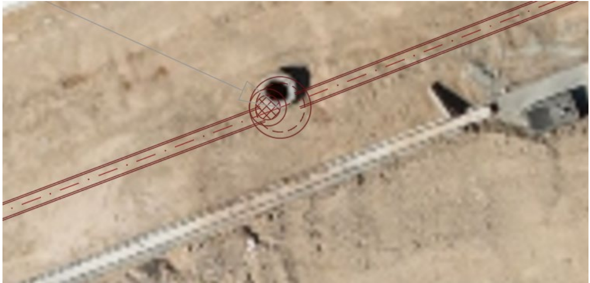
Εικόνα 43 - Σύγκριση θέσης κατασκευασμένου φρεατίου ακαθάρτων με θέση φρεατίου από μελέτη
