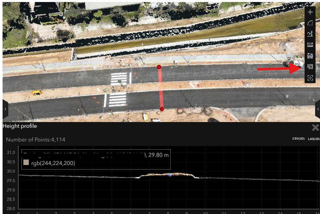
Εικόνα 47 - Μέτρηση υψομέτρων οδού μέσω του point cloud
