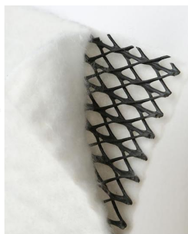
Εικόνα 5. Αριστερά: ιαστρωμάτωση τελικής κάλυψης Χ.Υ.Τ.Α. που περιλαμβάνει στρώσεις φυτικού εδάφους, αποστράγγισης όμβριων, γεωσυνθετικών υλικών (geonet, geogrid), στεγανοποίησης (γεωμεμβράνη και αργιλικό φραγμό), καθώς και σύστημα συλλογής βιοαερίου (Πηγή: Carrubba, 2024); Δεξιά: Γεωδικτυωτό (geonet) ως γεωσυνθετικό υλικό αποστράγγισης (Πηγή: WANSHENGLI., n.d.)
