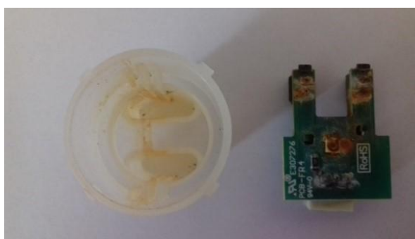
Εικόνα 5. Ο αισθητήρας της θολότητας τέθηκε εκτός λειτουργίας λόγω διάβρωσης
