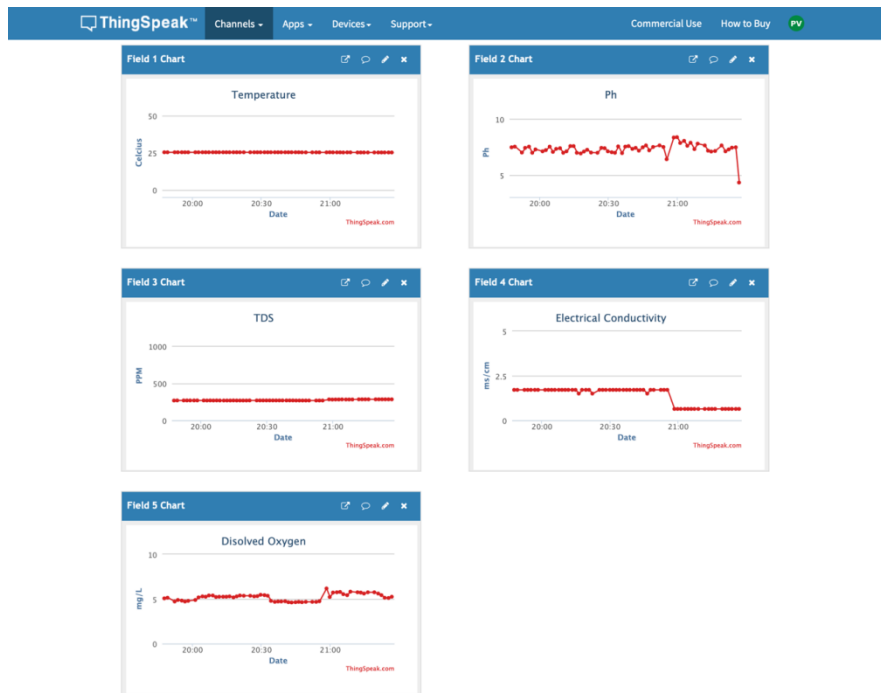
Εικόνα 15. Διαγράμματα των φυσικοχημικών παραμέτρων στην πλατφόρμα ThingSpeak
