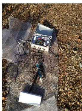
Εικόνα 9. Μετρήσεις φυσικοχημικών παραμέτρων του νερού της λίμνης με την πρωτότυπη συσκευή
