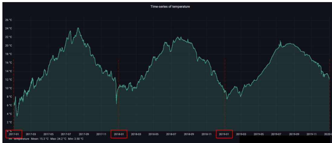
Εικόνα 25. Η αποτύπωση της ετήσιας διακύμανσης της θερμοκρασίας για την τριετία 2017-2020, στον σταθμό «Αλαμάνα» στο ποταμό Σπερχειό.
