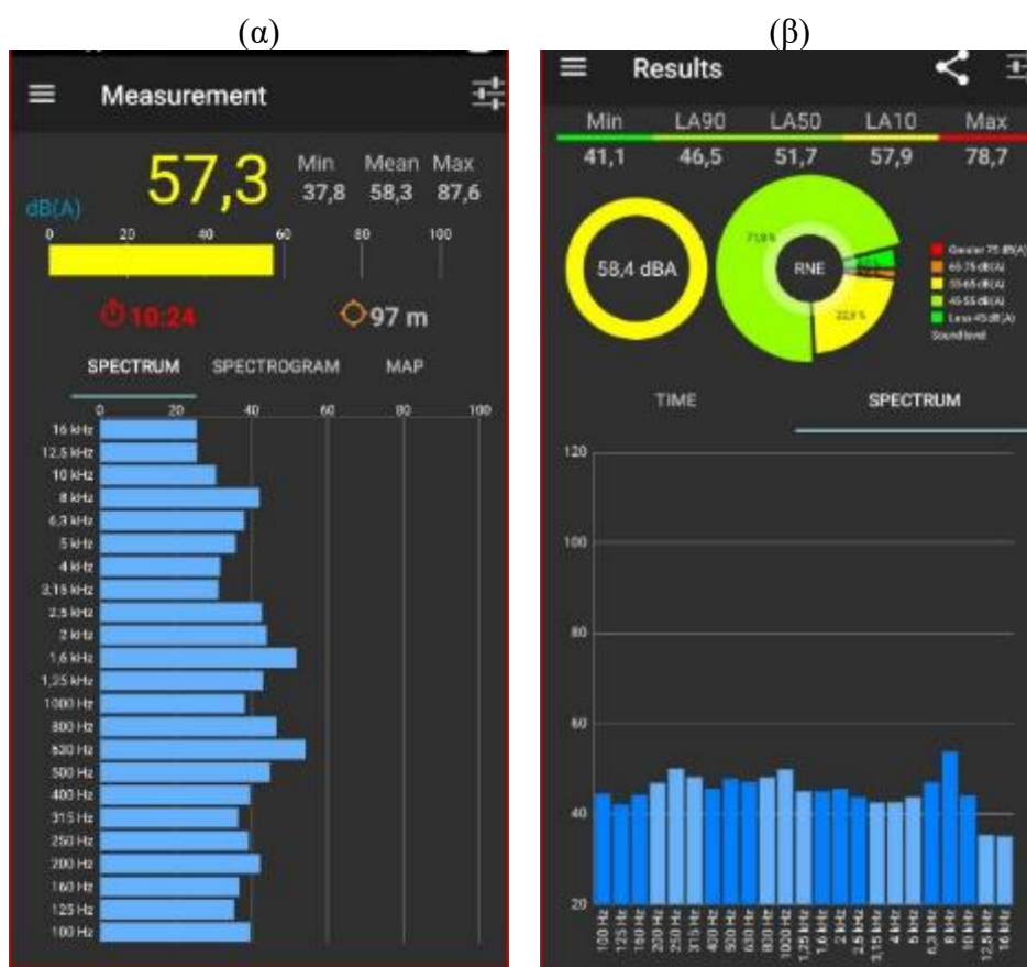
Εικόνα 24. Κενή αίθουσα Μοσχάτου: (α) φασματική αποτύπωση κατά τη διάρκεια της μέτρησης, (β) τελικές τιμές και φασματική κατανομή
