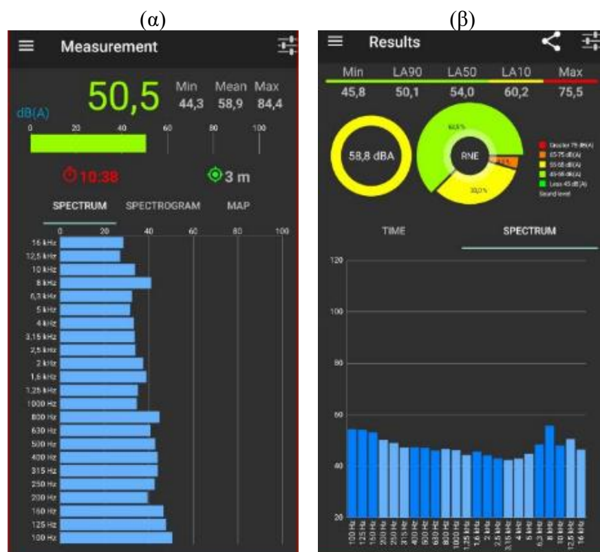
Εικόνα 28. ΜΟ-ΕΞ1 (Μοσχάτο - εξωτερική μέτρηση): (α) φασματική αποτύπωση κατά τη διάρκεια της μέτρησης, (β) τελικές τιμές και φασματική κατανομή
