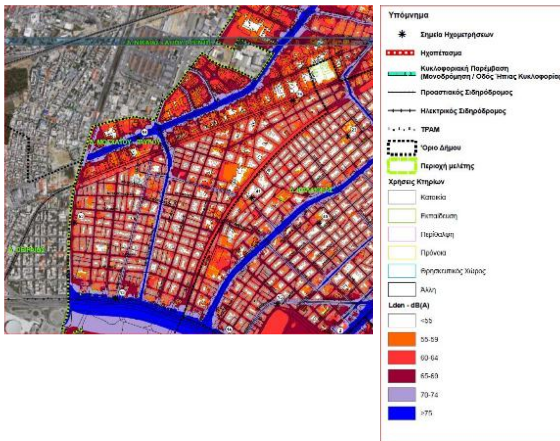
Εικόνα 15. Απόσπασμα στρατηγικού χάρτη περιβαλλοντικού θορύβου Lden από οδικές υποδομές για την περιοχή του ΒΝΣ Μοσχάτου, με το αντίστοιχο υπόμνημα. (Υπουργείο Περιβάλλοντος και Ενέργειας, Αξιολόγηση Περιβαλλοντικού θορύβου στο πλαίσιο εφαρμογής της Οδηγίας 2002/49/EK για τα Πολεοδομικά Συγκροτήματα Αθήνας και Θεσσαλονίκης & Σερρών - Μελέτη Μ.5, Νότια Αθήνα , απόσπασμα στρατηγικού χάρτη θορύβου Lden από οδικές υποδομές).
