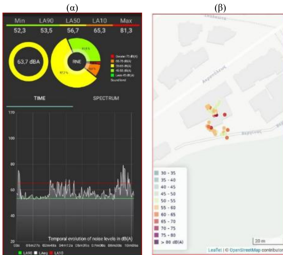
Εικόνα 54. ΧΑ-K2 (Χαϊδάρι - κύρια καταγραφή κενής αίθουσας): (α) χρονική εξέλιξη της στάθμης, (β) χαρτογραφική ένδειξη της εφαρμογής NoiseCapture.
