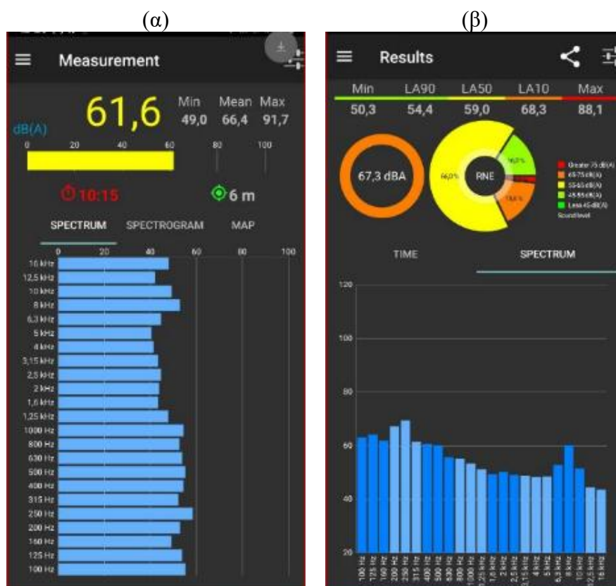
Εικόνα 35. ΠΕ-ΕΞ1 (Περιστερί - εξωτερική μέτρηση): (α) φασματική αποτύπωση κατά τη διάρκεια της μέτρησης, (β) τελικές τιμές και φασματική κατανομή
