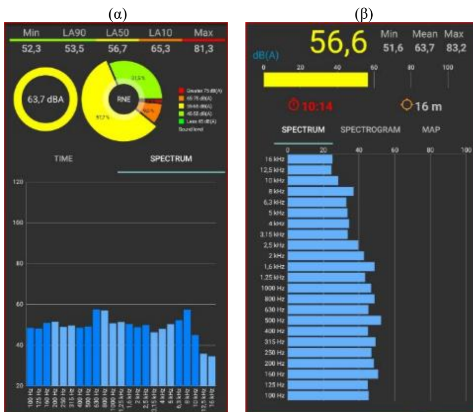
Εικόνα 38. Τεκμηρίωση της κύριας μέτρησης κενής αίθουσας XA-K2: (α) τελικές ενδείξεις και φασματική κατανομή, (β) φασματική σύνθεση κατά τη διάρκεια της μέτρησης, εφαρμογή NoiseCapture
