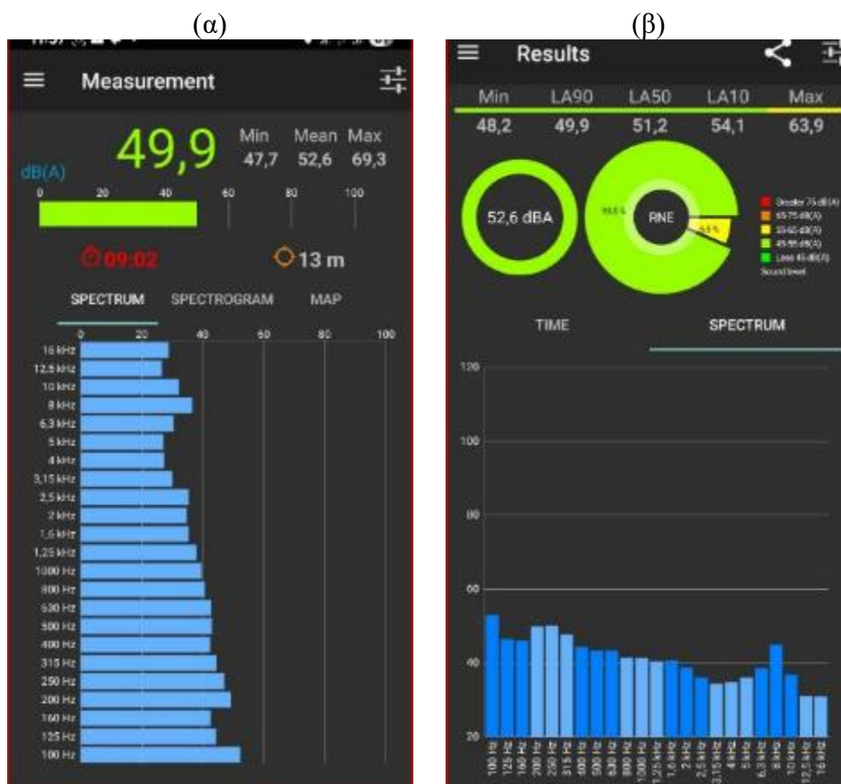
Εικόνα 31. ΠΕ-K1 (Περιστέρι - κενή αίθουσα): (α) φασματική αποτύπωση κατά τη διάρκεια της μέτρησης, (β) τελικές τιμές και φασματική κατανομή
