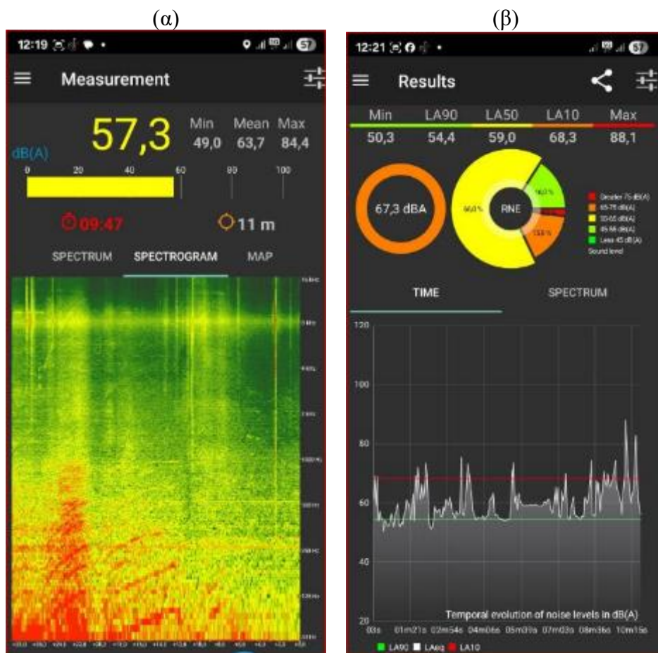
Εικόνα 51. ΠΕ-ΕΞ1 (Περιστέρι - εξωτερική μέτρηση): (α) φασματογράφημα της εξωτερικής καταγραφής, (β) χρονική εξέλιξη της στάθμης κατά τη δεκάλεπτη μέτρηση.
