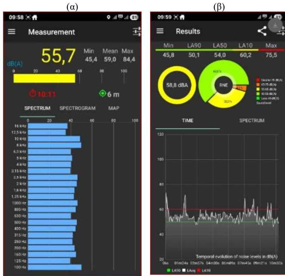
Εικόνα 48. MO-EΞ1 (Μοσχάτο - εξωτερική μέτρηση): (α) συμπληρωματική φασματική αποτύπωση κατά τη διάρκεια της εξωτερικής καταγραφής, (β) χρονική εξέλιξη της στάθμης κατά τη δεκάλεπτη μέτρηση
