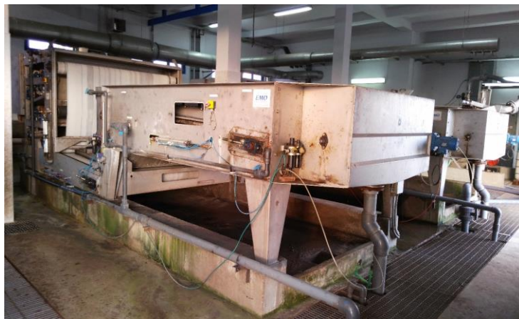
Εικόνα 18 : Ταινιοφιλτρόπρεσσα EMO Μονάδας Αφυδατωμένης Ιλύος (Δ.Ε.Υ.Α.Σ.,2023 )
