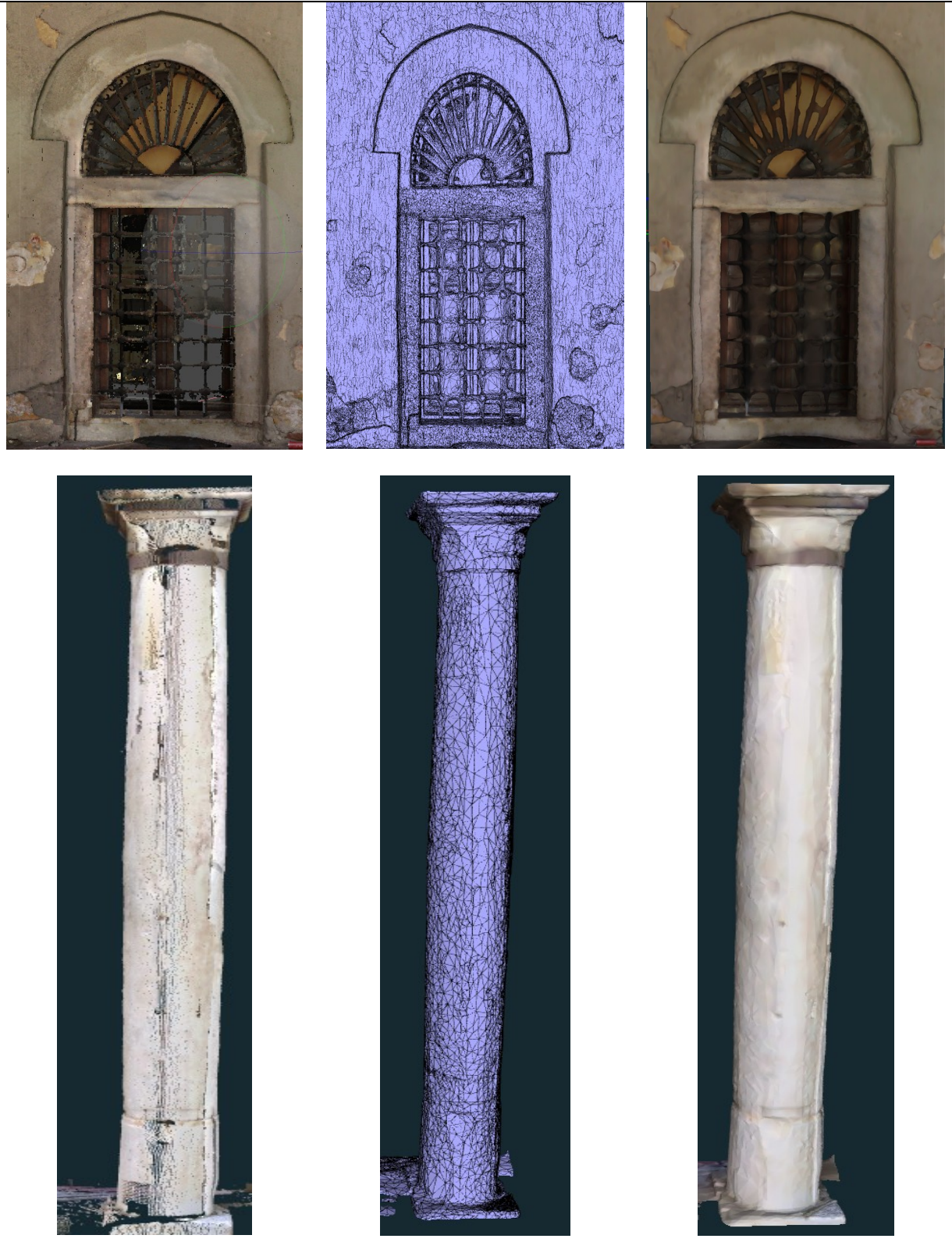
Πίνακας 13 Λεπτομέρεια αναπαράστασης επιφάνειας του μνημείου σε τρεις μορφές: νέφος σημείων (point cloud), τριγωνισμένο πλέγμα (mesh σε μορφή wireframe) και τελικό mesh
