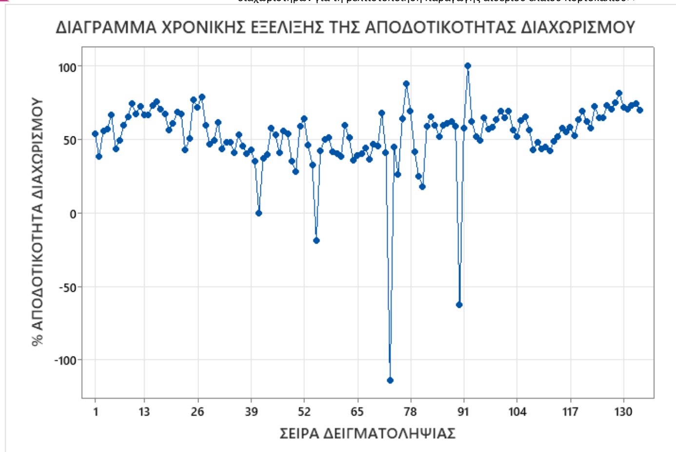
Εικόνα 4 Διάγραμμα χρονικής εξέλιξης της αποδοτικότητας διαχωρισμού του φυγοκεντρικού διαχωριστήρα κατά τη διάρκεια της βιομηχανικής λειτουργίας.
