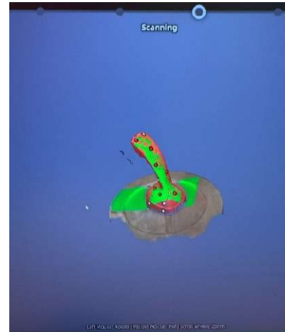
Εικόνα 65: Στιγμιότυπο λογισμικού EXScan Pro — ανίχνευση δεικτών στην επιφάνεια του τηλεφώνου κατά τη σάρωση. Πηγή: προσωπικό αρχείο.
