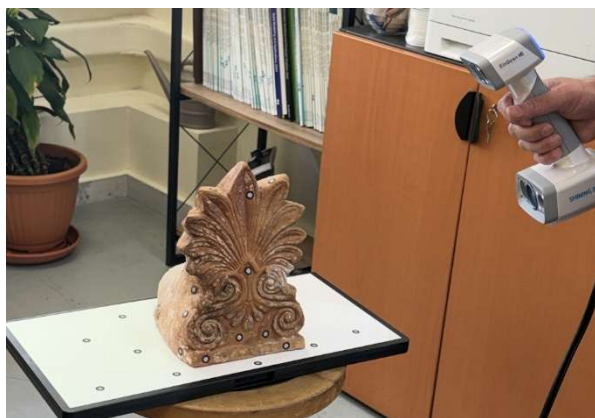
Εικόνα 12: Σάρωση αντικειμένου με Shining3D EinScan H2 σε λειτουργία handheld. Διακρίνονται οι ανακλαστικοί δείκτες τοποθετημένοι στην επιφάνεια του αντικειμένου. Πηγή: προσωπικό αρχείο.
