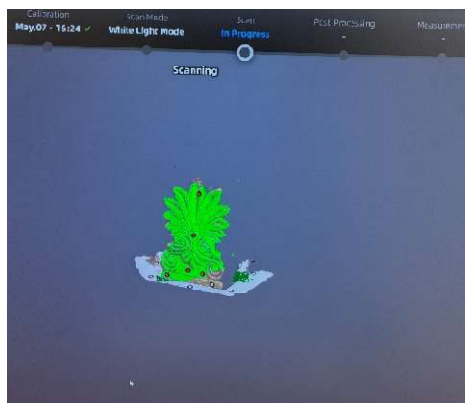
Εικόνα 62: Στιγμιότυπο λογισμικού EXScan Pro κατά τη σάρωση ακροκέραμου σε White Light Mode (In Progress). Πηγή: προσωπικό αρχείο.
