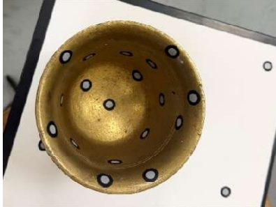
Εικόνα 64: Σάρωση ακροκέραμου με Shining3D EinScan H2. Διακρίνονται οι ανακλαστικοί δείκτες τοποθετημένοι στην επιφάνεια του αντικειμένου. Πηγή: προσωπικό αρχείο.
