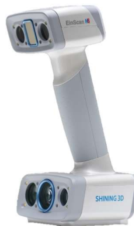
Εικόνα 7: Ο σαρωτής δομημένου φωτός Shining3D EinScan H2. Πηγή: https://www.einscan.com
