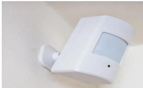
Εικόνα 38 Αισθητήρας PIR. Πηγή https://www.istockphoto.com/photo/motion-sensor-or-detector-for-security-system-mounted-on-wall-gm541851046-96902479?searchscope=image%2Cfilm
