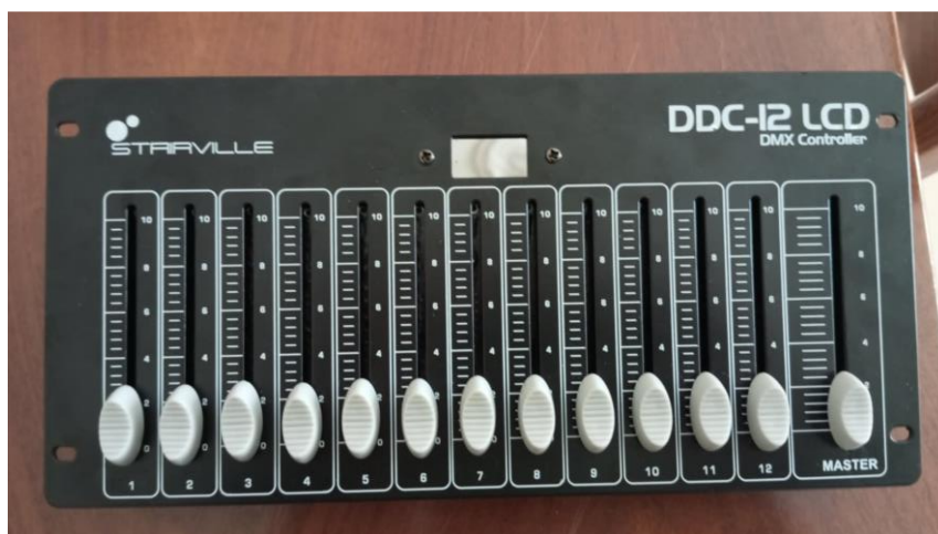
Εικόνα 7 Προσωπικό αρχείο σπουδαστή Κόκκου Θεόδωρου. Κονσόλα φωτισμού DMX 12 καναλιών.
