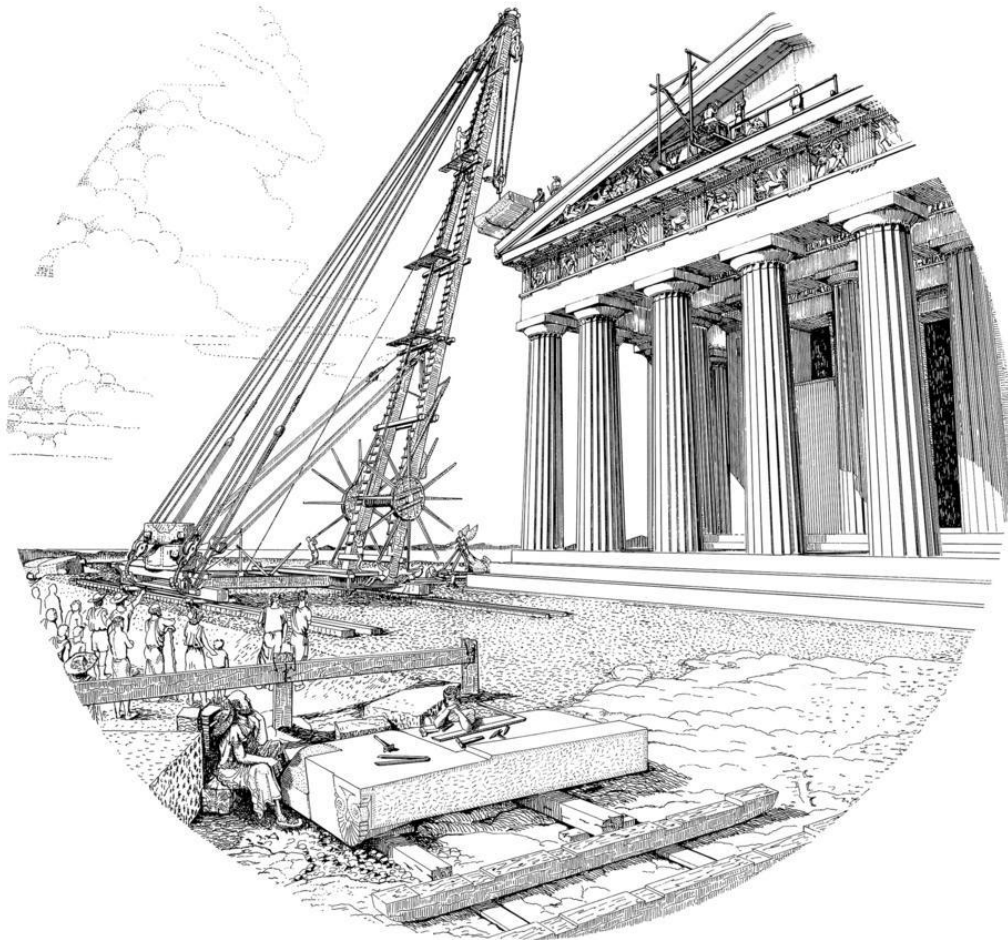
Εικόνα 4: Σχεδιαστική αναπαράσταση ξύλινου ανυψωτικού γερανού από το βιβλίο του Μανώλη Κορρέ "Από την Πεντέλη στον Παρθενώνα".
