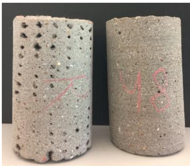
Εικόνα 25: Δείγματα εκτυπωμένου σκυροδέματος καλής ποιότητας εκτύπωσης στα δεξιά και χαμηλής ποιότητας εκτύπωσης στα αριστερά, όπου διακρίνεται το περίγραμμα των νημάτων υλικού και τα αντίστοιχα κενά ανάμεσά τους
