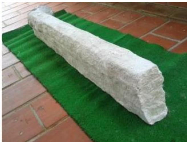
Εικόνα 30: Δοκός κατασκευασμένη από σκυρόδεμα με βάση το MgO, όπου διακρίνεται η χαρακτηριστική τραχεία εξωτερική επιφάνεια
