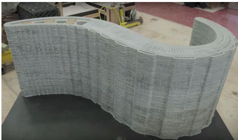
Εικόνα 18: Κατασκευή εκτυπωμένη με τη μέθοδο Concrete Printing, με το χαρακτηριστικό ραβδωτό τελείωμα
