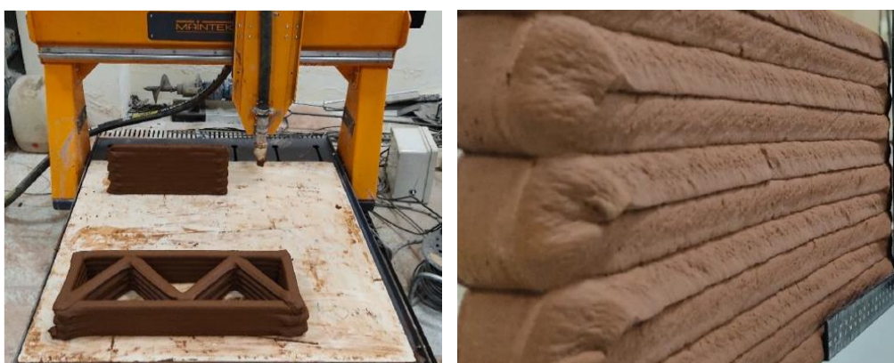
Εικόνα 24: Το γεωπολυμερές κονίαμα, που αποτελείται εξ' ολοκλήρου από απόβλητα κατασκευών και κατεδαφίσεων. Αριστερά: εικόνα κατά την εκτύπωση του μίγματος στο εργαστήριο. Δεξιά: Κοντινή φωτογραφία των στρώσεων του υλικού μετά την εξώθηση
