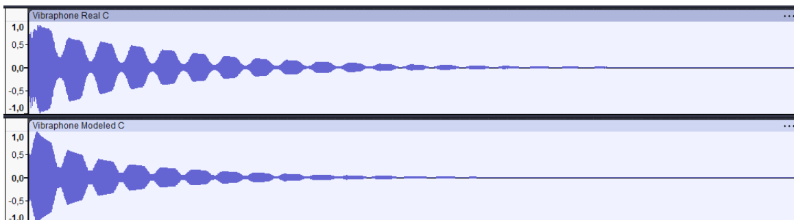
Εικόνα 28: Γενικές κυματομορφές πραγματικού - μοντέλου βιμπράφωνου
