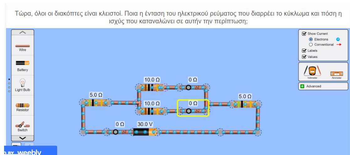
Εικόνα 4.44.4: Σύνθετο κύκλωμα – Υπολογισμός Έντασης Ηλεκτρικού Ρεύματος - Ισχύος
