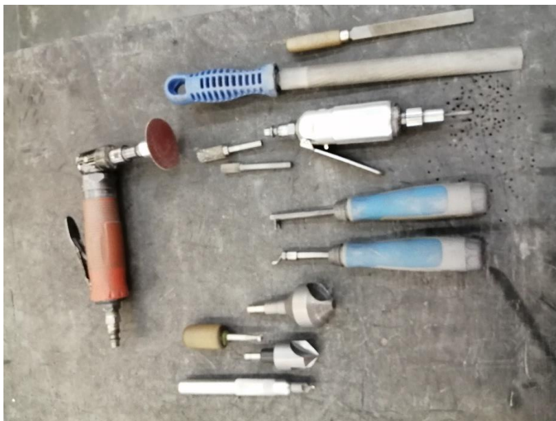
Εικόνα 4.6. Εργαλεία για απογρέζωση: Λίμες, απογρεζωτές, φρέζες, τροχός
