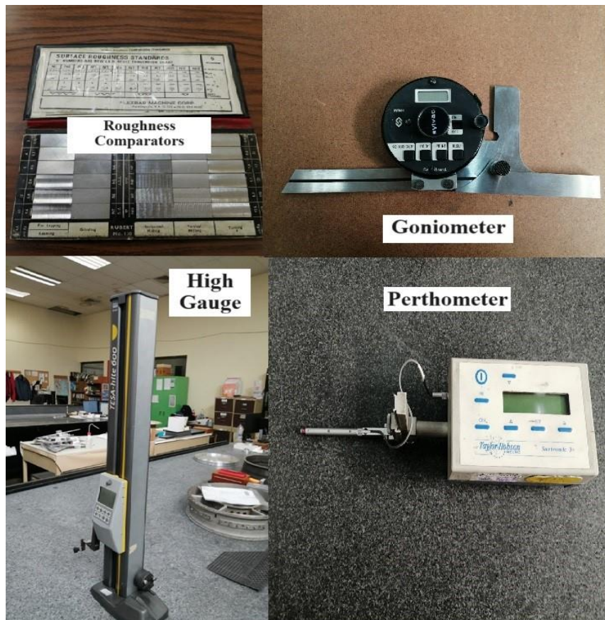
Εικόνα 4.10. Μετρητικά όργανα: High gauge, goniometer, perthometer, roughness comparators.
