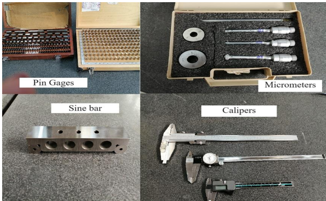
Εικόνα 4.9. Μετρητικά όργανα: Pin gages, micrometers, Sine bar, Calipers
