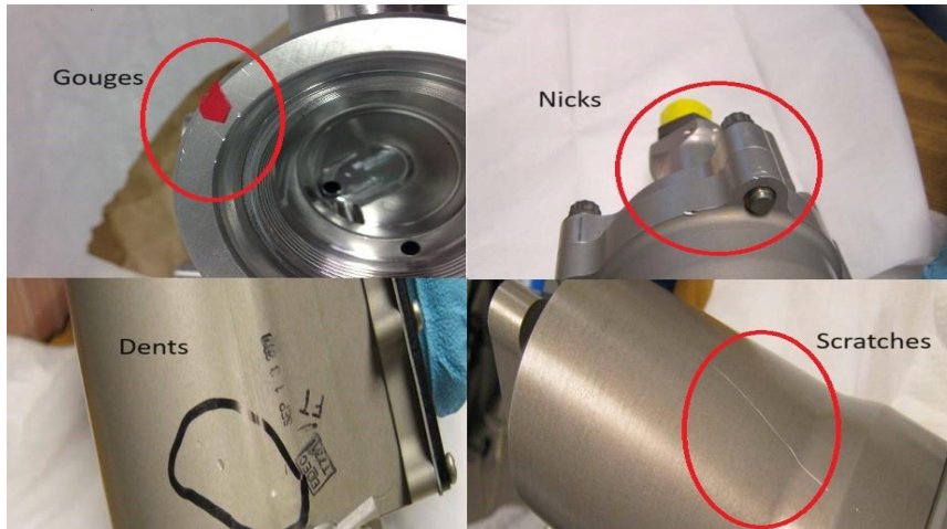
Εικόνα 4.7. Παραδείγματα ελαττωμάτων κατά τον οπτικό έλεγχο (PMD Inc. (2017))
