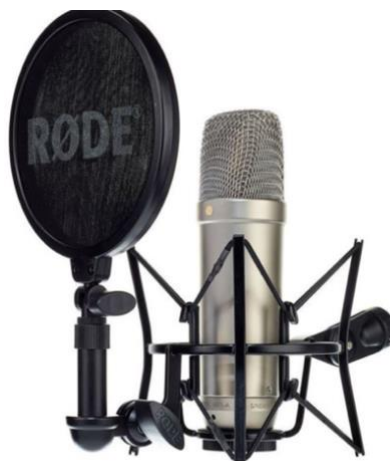
Εικόνα 1.22 Απεικόνιση ενός τυπικού πυκνωτικού μικροφώνου. ( https://mikrofon-tests.de )
