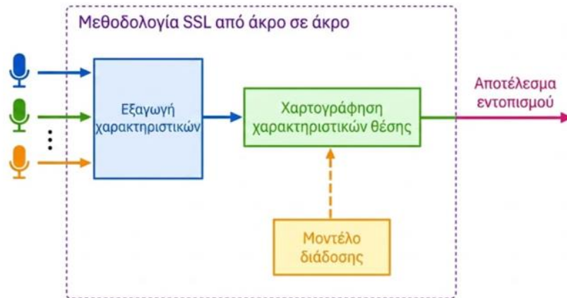
Εικόνα 3.3 Απεικόνιση της συνολικής διαδικασίας αναγνώρισης ηχητικής πηγής με τη μεθοδολογία τελικής καθοδηγούμενης επεξεργασίας. (Rascon, 2016)
