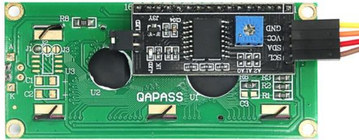
Εικόνα 4.21 Απεικόνιση της οθόνης LCD με ενσωματωμένη μονάδα διεπαφής I2C. ( www.amazon.de )
