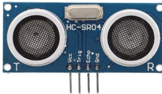
Εικόνα 4.14 Απεικόνιση του αισθητήρα υπερήχων HC-SR04. ( www.amazon.de )
