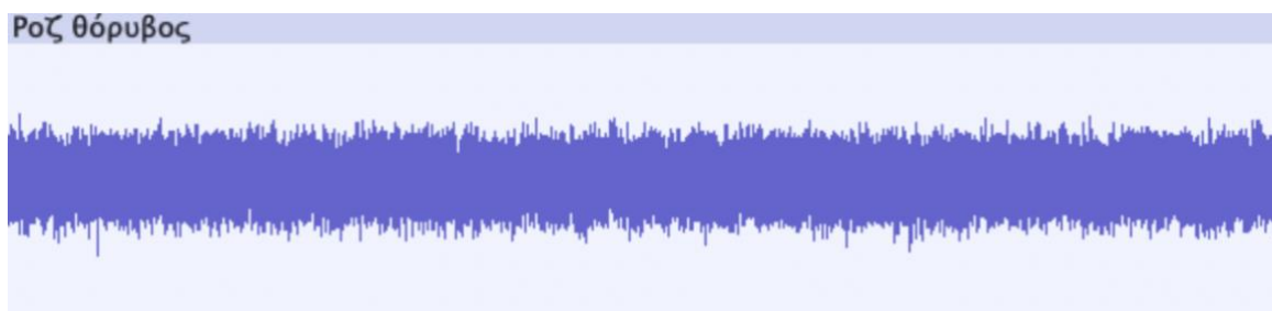
Εικόνα 1.13 Απεικόνιση του σήματος ροζ θορύβου στο πεδίο του χρόνου με το λογισμικό Audacity.
