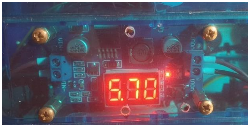
Εικόνα 4.3 Απεικόνιση του υποβιβαστή τάσης με ενσωματωμένη ένδειξη τάσης μπαταριών
