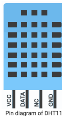
Εικόνα 4.24 Απεικόνιση του αισθητήρα DHT 11. ( www.electronicwings.com )
