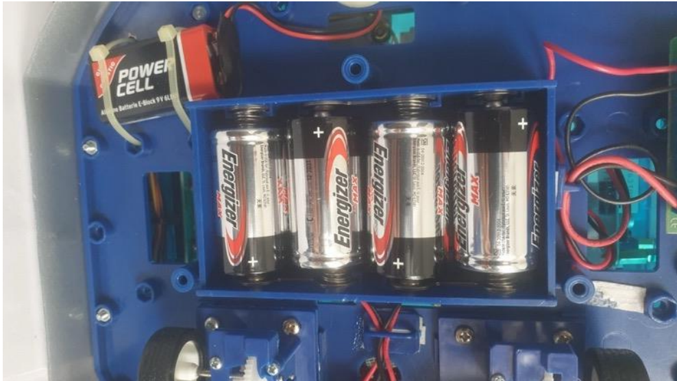
Εικόνα 4.2 Απεικόνιση των πηγών τροφοδοσίας του ρομποτικού οχήματος. Στο κέντρο της εικόνας απεικονίζεται η συστοιχία μπαταριών που παρέχει τάση 6V DC, ενώ στο επάνω αριστερό τμήμα διακρίνεται η μπαταρία που παρέχει τάση 9V DC.
