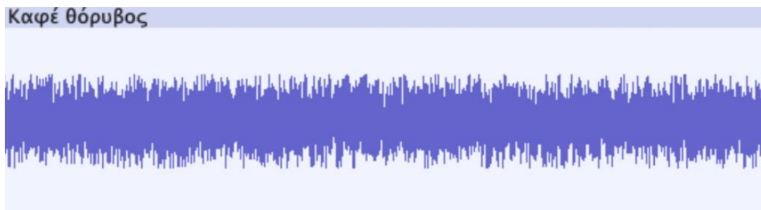
Εικόνα 1.15 Απεικόνιση του σήματος καφέ θορύβου στο πεδίο του χρόνου με το λογισμικό Audacity.
