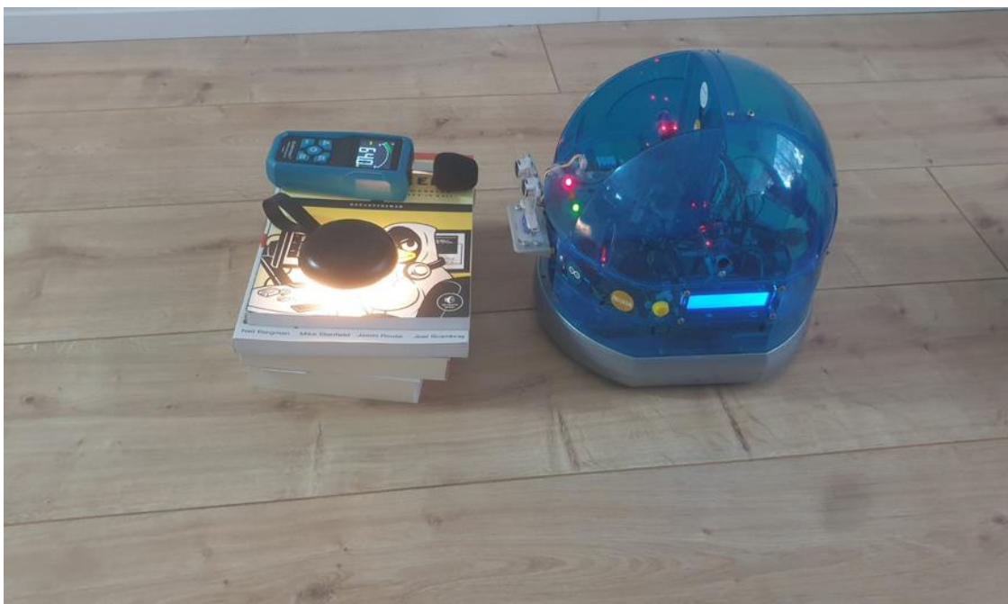
Εικόνα 4.64 Απεικόνιση του ρομποτικού οχήματος κατά τον εντοπισμό της ηχητικής πηγής.
