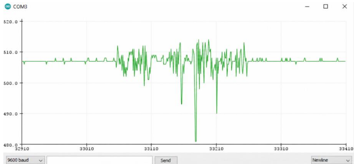
Εικόνα 4.32 Απεικόνιση της κυματομορφής των τιμών της αναλογικής εξόδου του μικροφώνου.
