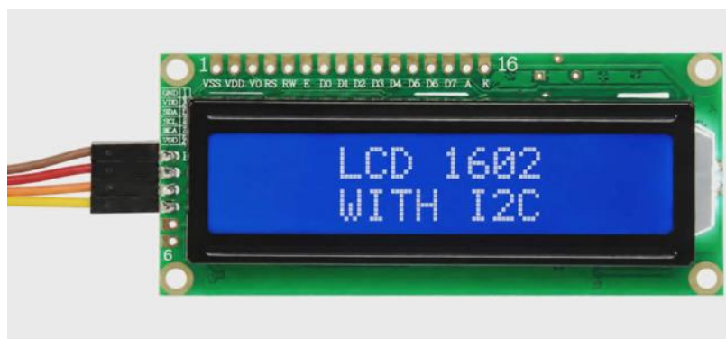
Εικόνα 4.20 Απεικόνιση της οθόνης LCD δύο γραμμών με δεκαέξι χαρακτήρες ανά γραμμή. ( www.amazon.de )
