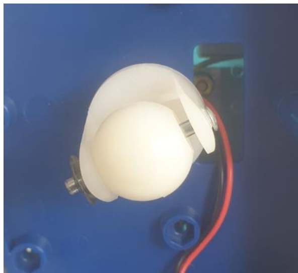
Εικόνα 4.7 Απεικόνιση του οπίσθιου ελεύθερου τροχού του ρομποτικού οχήματος
