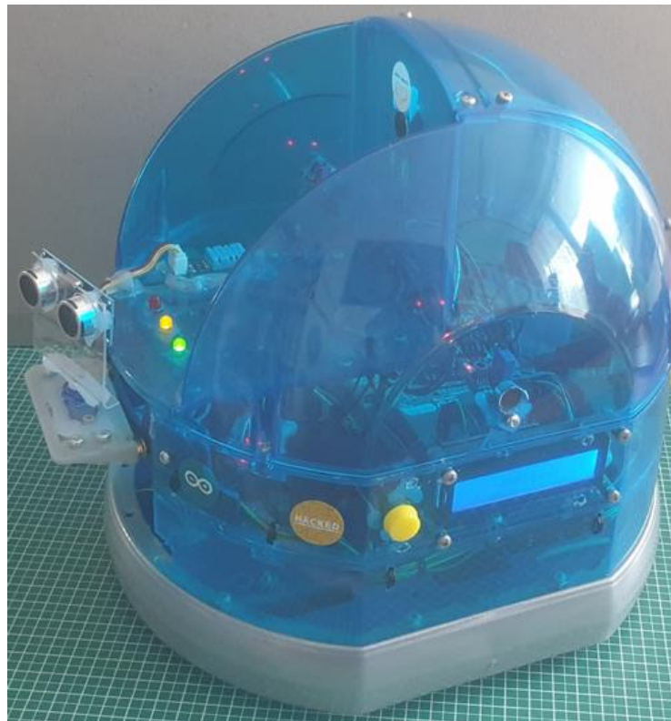
Εικόνα 4.37 Απεικόνιση του ρομποτικού οχήματος κατά τη λειτουργία κίνησης προς την ηχητική πηγή.
