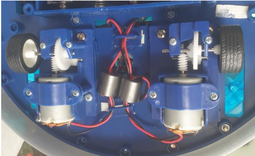
Εικόνα 4.8 Απεικόνιση των δύο εμπρόσθιων τροχών, των κινητήρων και του συστήματος οδοντωτών τροχών (γρاناζιών).
