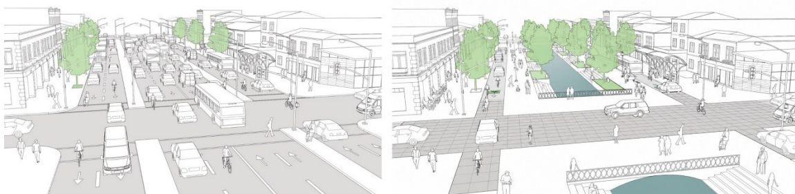
Εικόνα 32 Επεξηγηματικό διάγραμμα της πρακτικής του stream daylighting. [Πηγή: https://globaldesigningcities.org/publication/global-street-design-guide/streets/special-conditions/streets-to-streams/example-40-m/ ].
