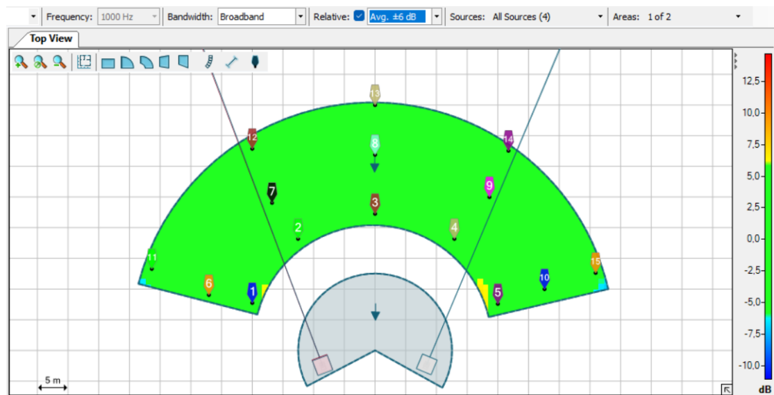
Εικ. 6.37. Απεικόνιση πρόβλεψης στάθμης αρχαίου θεάτρου Δίου από το λογισμικό EASE focus με απόκλιση \pm 6\text{dB} , στην πράσινη περιοχή
