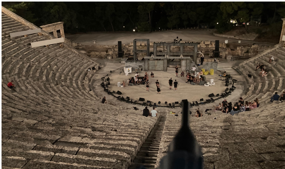
Εικ. 6.15. Άποψη του αρχαίου θεάτρου Επιδαύρου από την θέση χειριστή ήχου στη μέση του 1 ου διαζώματος. Σε πρώτο πλάνο το μικρόφωνο των μετρήσεων STO-2
