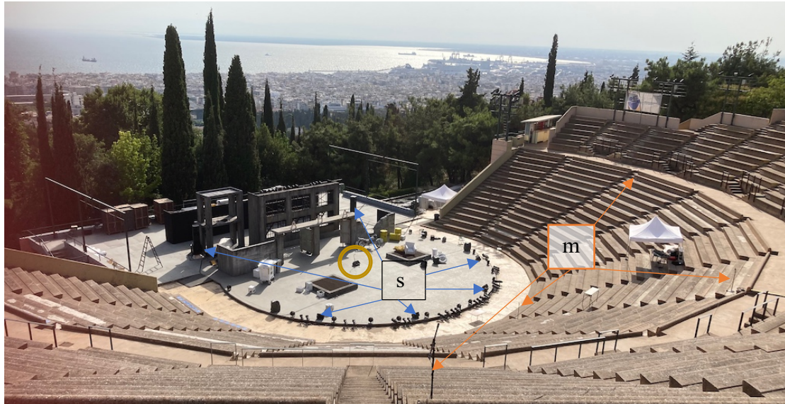
Εικ.5.6. Άποψη του θεάτρου Δάσους με τα ηχεία (s) που χρησιμοποιήθηκαν για τις μετρήσεις καθυστέρησης (εκτός των κεντρικών) και τα μικρόφωνα που τις κατέγραψαν (m)
