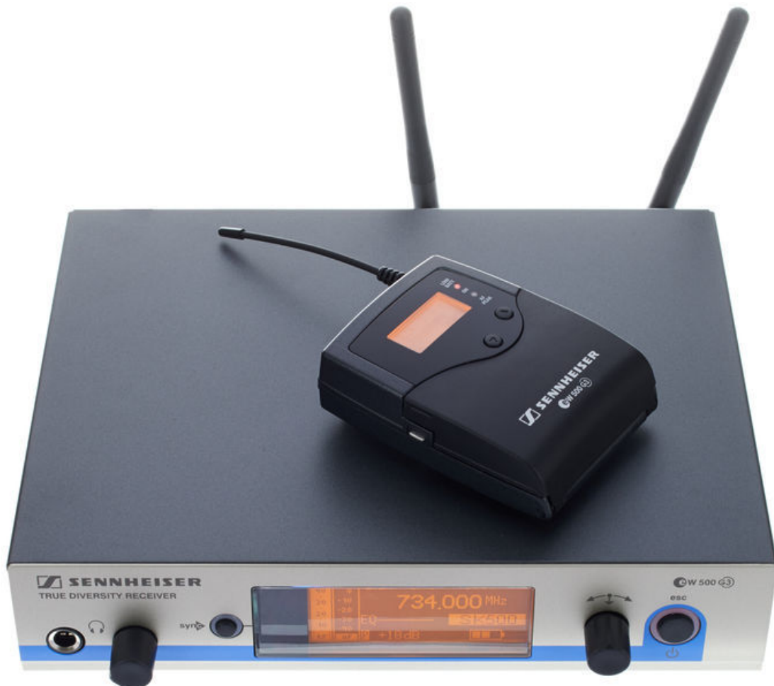
Εικ. 3.10. Το ασύρματο σύστημα ew 500 G3, της Sennheiser
