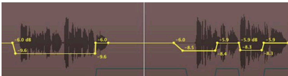
Εικ. 3.17. Απεικόνιση αυτοματισμού στάθμης σε επίπεδο λέξης σε λογισμικό
