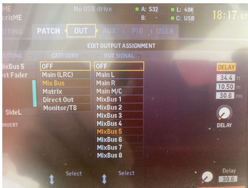
Εικ.5.26. Η καθυστέρηση εξόδου στα FF ηχεία, τα οποία παίρνουν σήμα από το MixBus 5 στην ψηφιακή X32, σε ft (πόδια), m (μέτρα) και ms (millisecond)
