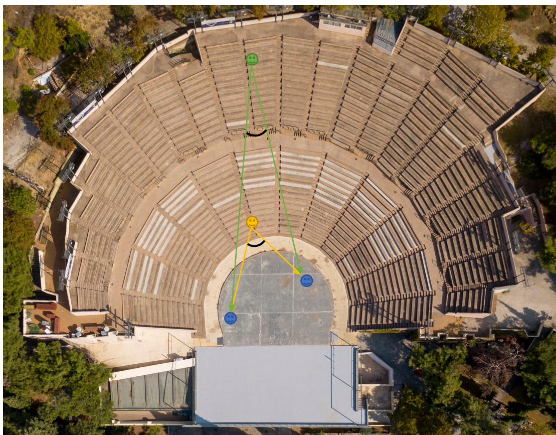
Εικ. 4.5. Η διαφορά στις γωνίες ακρόασης μεταξύ των διαφορετικών θέσεων του θεάτρου, παίζει καθοριστικό ρόλο στον εντοπισμό της πηγής ήχου, στο ανοιχτό θέατρο (κάτοψη του θεάτρου Δάσους) 24
