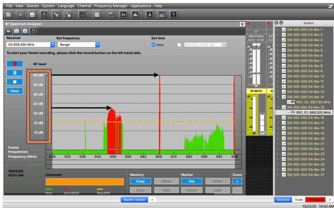
Εικ. 3.13. Αναπαράσταση σήματος μικροφώνων, θορύβου και ρύθμιση του Squelch
