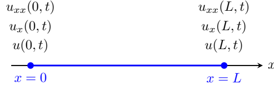
Σχήμα 3.1: ΜΔΕ: u_t + u_{xxx} = 0 σε ευθύγραμμο τμήμα.
