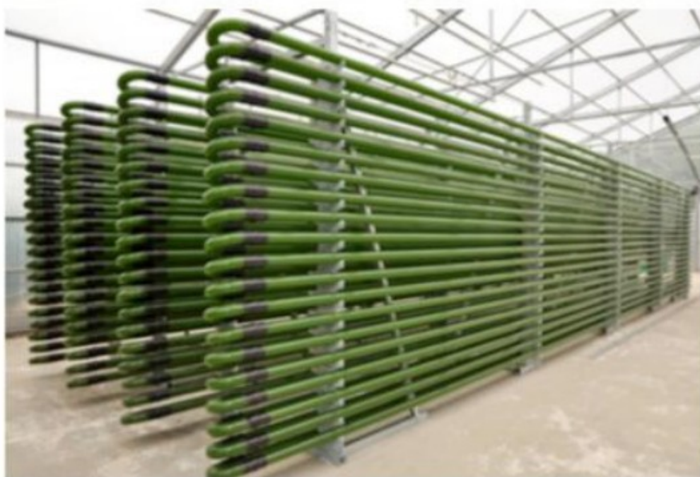
Εικόνα 7 Αυλωτός αντιδραστήρας καλλιέργειας μικροφυκών
