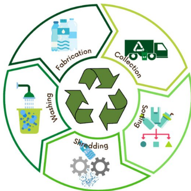
Εικόνα 13: Συνολική μηχανική διαδικασία ανακύκλωσης απορριμμάτων πλαστικών (vonVacanoetal., 2023).
