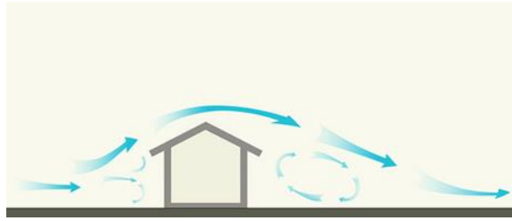
Εικόνα 18: Κάθετη απεικόνιση ροής ανέμου γύρω από κτίριο
