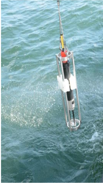
Εικόνα 25. Μέτρηση της ταχύτητας του ήχου (αριστερά) και ενδεικτικό διάγραμμα μεταβολής της ταχύτητας του ήχου στο νερό συναρτήσει του βάθους (δεξιά), (Makar, 2019).
