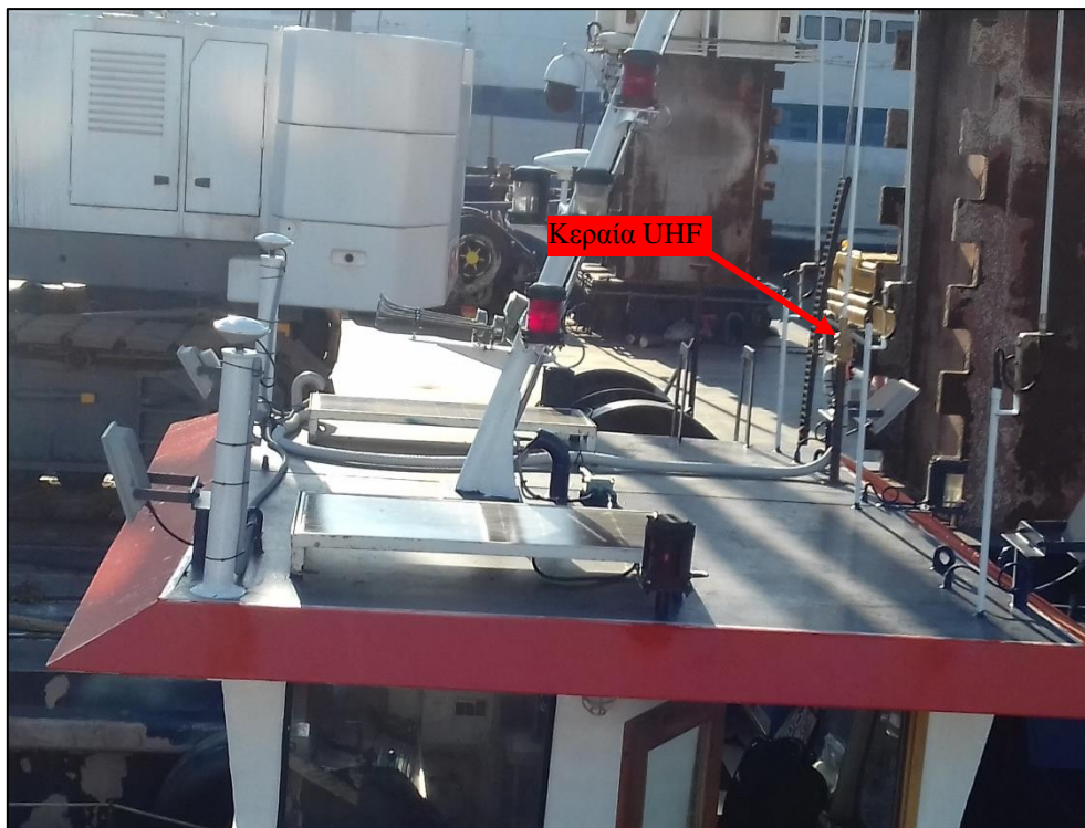
Εικόνα 14. Πλάγια όψη της γέφυρας με εγκατεστημένες τις κεραίες GNSS. Στα δεξιά διακρίνεται τοποθετημένη και η κεραία UHF.
