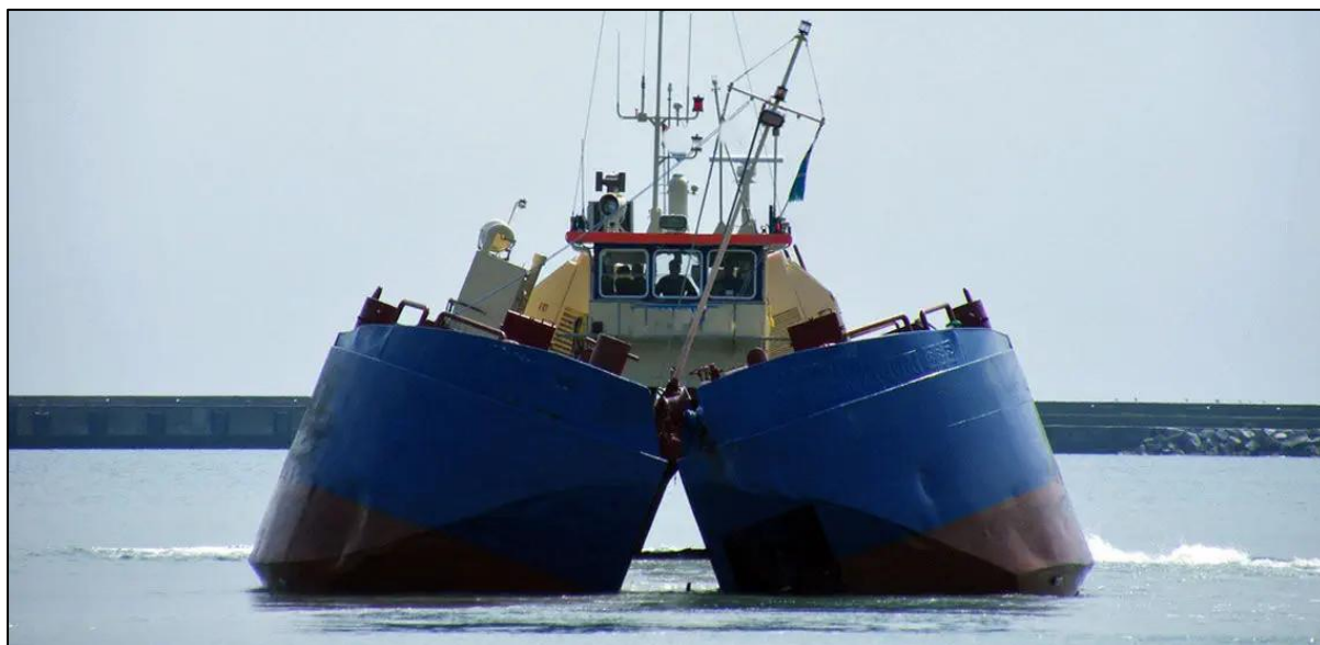
Εικόνα 6. Φορτηγίδα- κλαπέ με ανοιχτό κύτος (Λήψη από https://www.nauticexpo.com/prod/mavi-deniz/product-32743-535397.html ).
