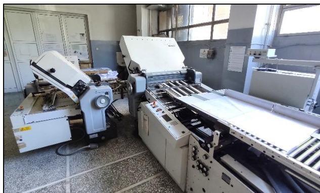
Εικόνα 26 Διπλωτική μηχανή στο σύγχρονο βιβλιοδετείο του ΤΥΕΣ. Πηγή: Αρχείο ΤΥΕΣ.
