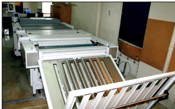
Εικόνα 31 Ο χώρος του CTP (Computer to Plate) στο ΤΥΕΣ, όπου η ψηφιακή προεκτύπωση και η απευθείας εγγραφή πλακών αντικατέστησαν σταδιακά τις παλαιότερες φωτοχημικές διαδικασίες. Πηγή: Αρχείο ΤΥΕΣ.
