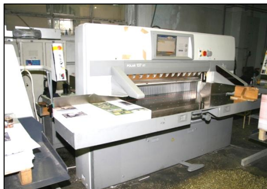
Εικόνα 27 Κοπτική μηχανή στο σύγχρονο βιβλιοδετείο του ΤΥΕΣ. Πηγή: Αρχείο ΤΥΕΣ.
