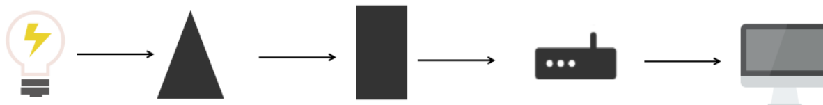
Εικόνα 5: Κύρια μέρη ενός UV-VIS φασματοφωτόμετρου[42].
