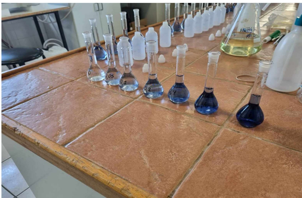
Εικόνα 28: Παρασκευή δειγμάτων πρότυπης καμπύλης P μέθοδο Murphy - Riley
