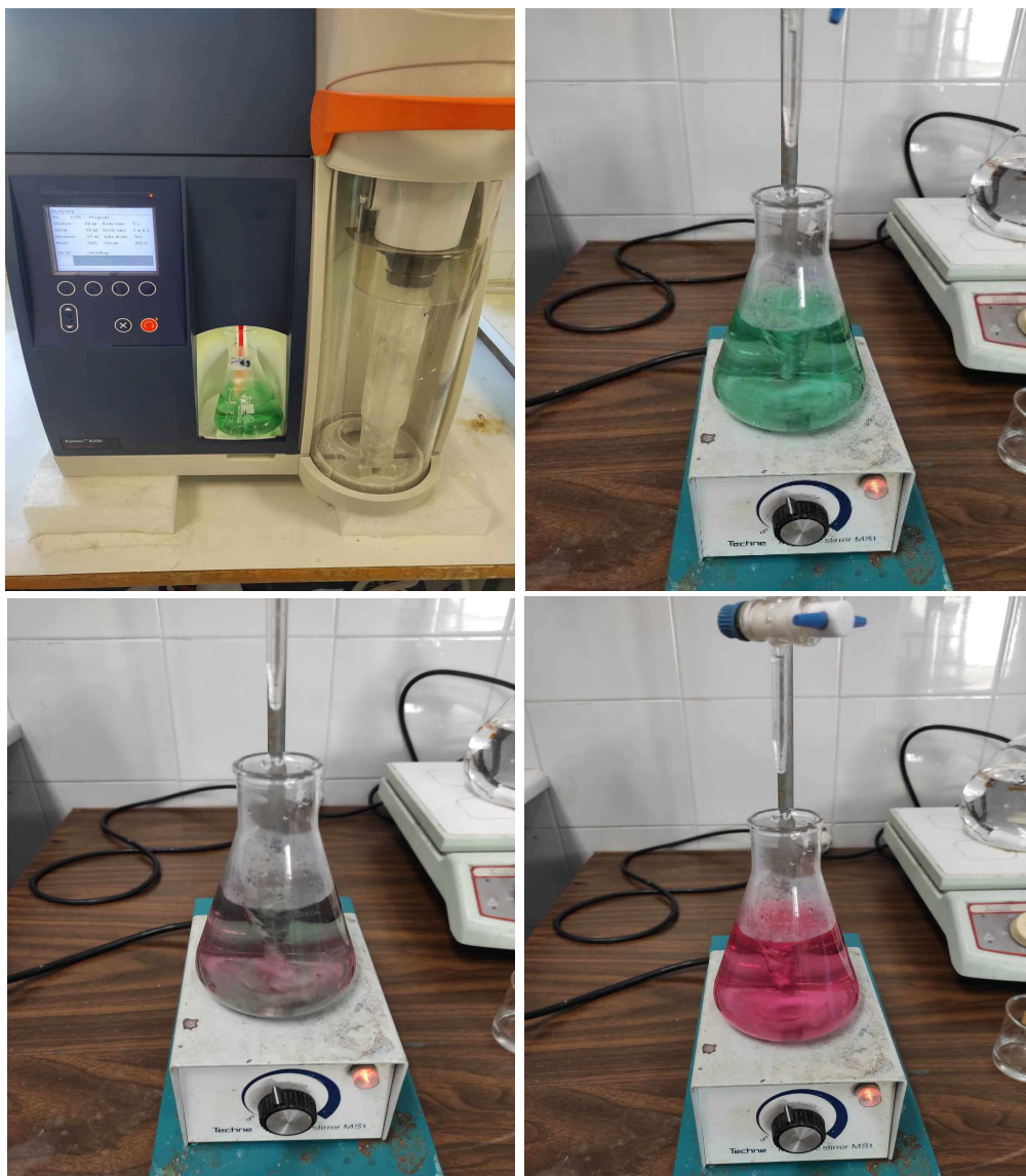
Εικόνα 27: Διαδικασία απόσταξης και τιτλοδεσίας με μέθοδο Kjeldahl
