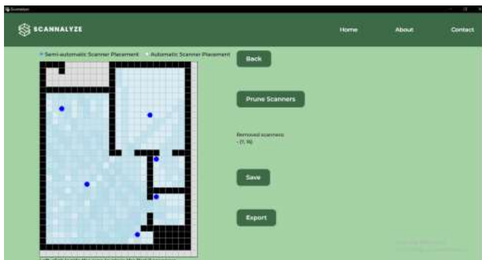
Εικόνα 22: Κλάδεμα σαρωτών μετά από ημιαντόματη τοποθέτηση
