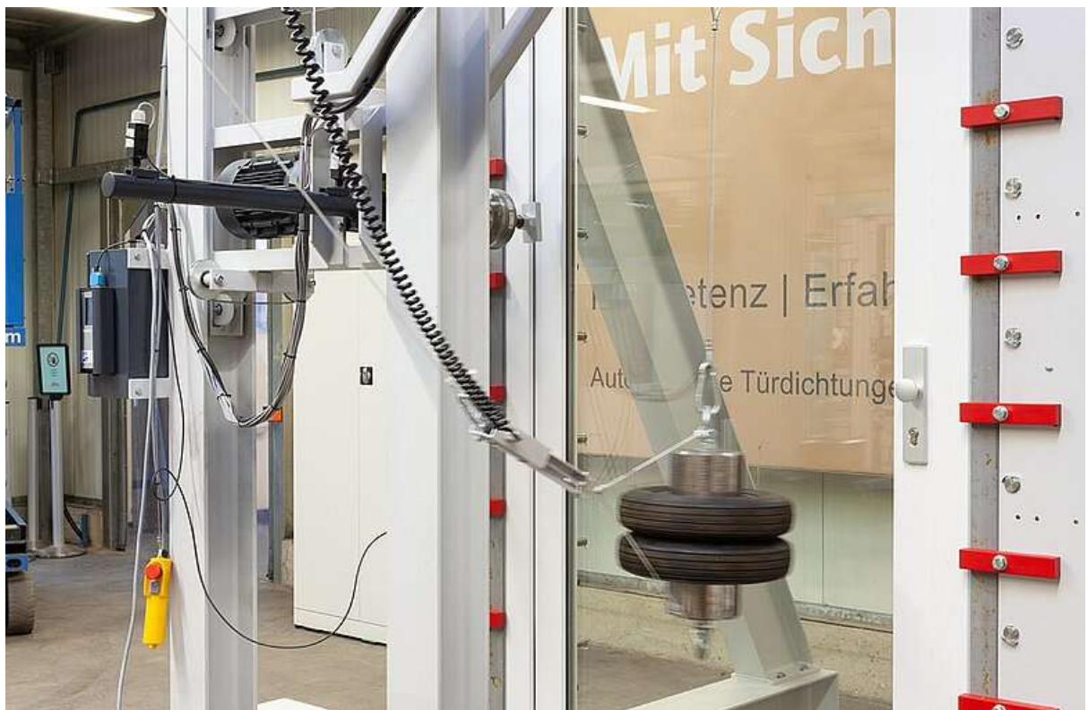
Σχήμα 2.13: Δοκιμή αντιδιαρρηκτικής προστασίας κουφώματος σύμφωνα με EN 1627
