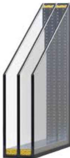
Σχήμα 2.18: Τριπλός υαλοπίνακας με διπλό διάκενο.
