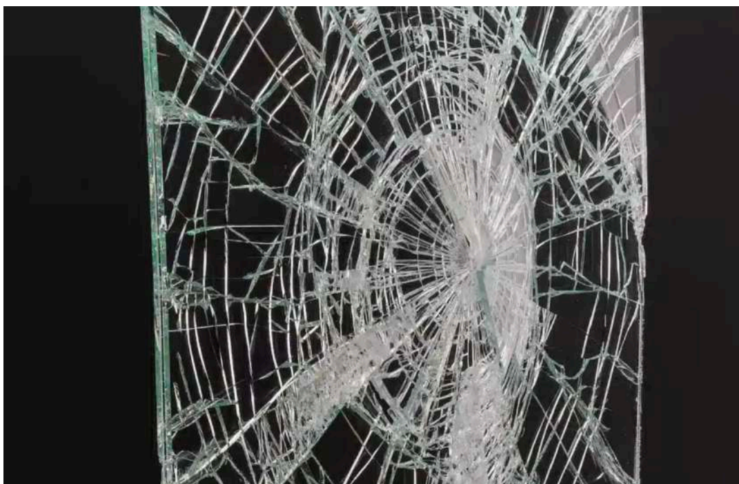
Σχήμα 2.22: Πολυστρωματικός υαλοπίνακας μετά από θραύση – τα θραύσματα παραμένουν συγκρατημένα από τη μεμβράνη.
