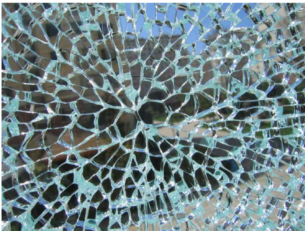
Σχήμα 2.21: Θραύση θερμικά σκληρυμένου υαλοπίνακα σε μικρά κοκκώδη τεμάχια.
