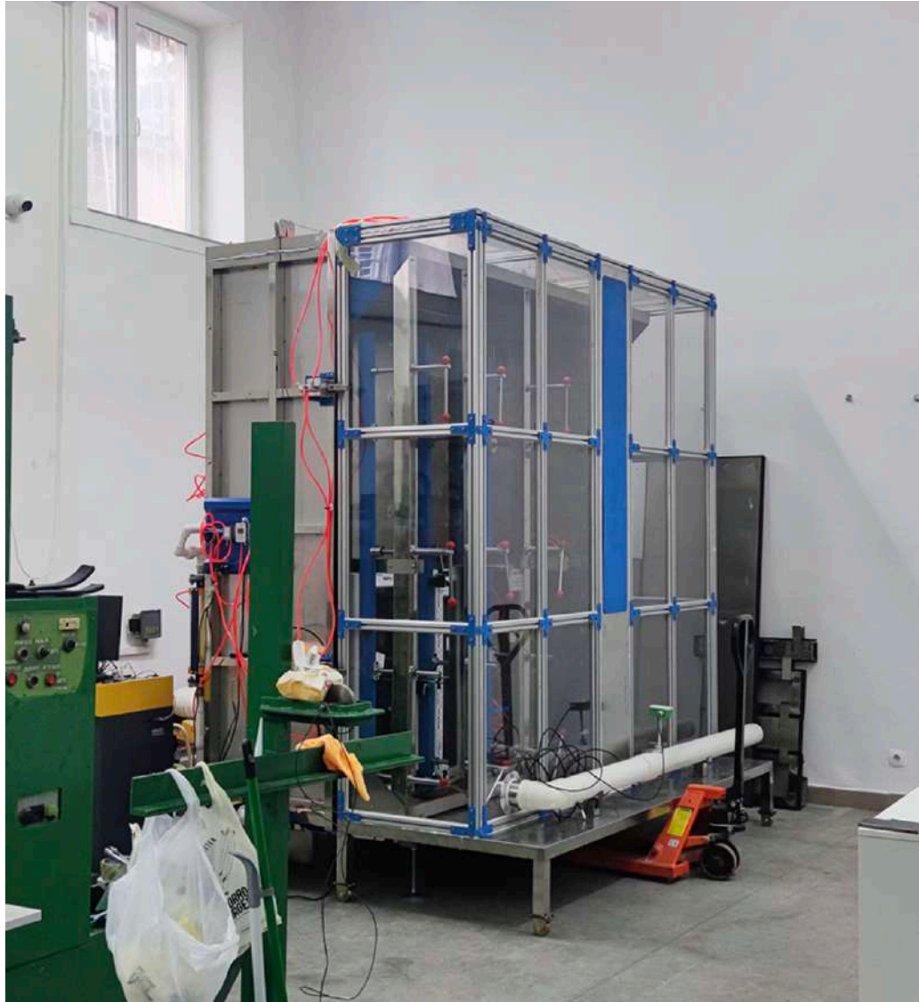
Σχήμα 2.10: Εργαστηριακή δοκιμή αντοχής σε ανεμοπίεση σύμφωνα με EN 12211. Το κούφωμα υποβάλλεται σε ελεγχόμενη διαφορική πίεση.
