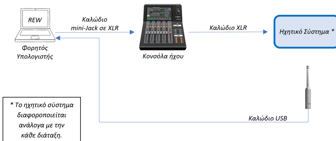
Σχήμα 4.1 Συνδεσμολογία του συστήματος μετρήσεων
