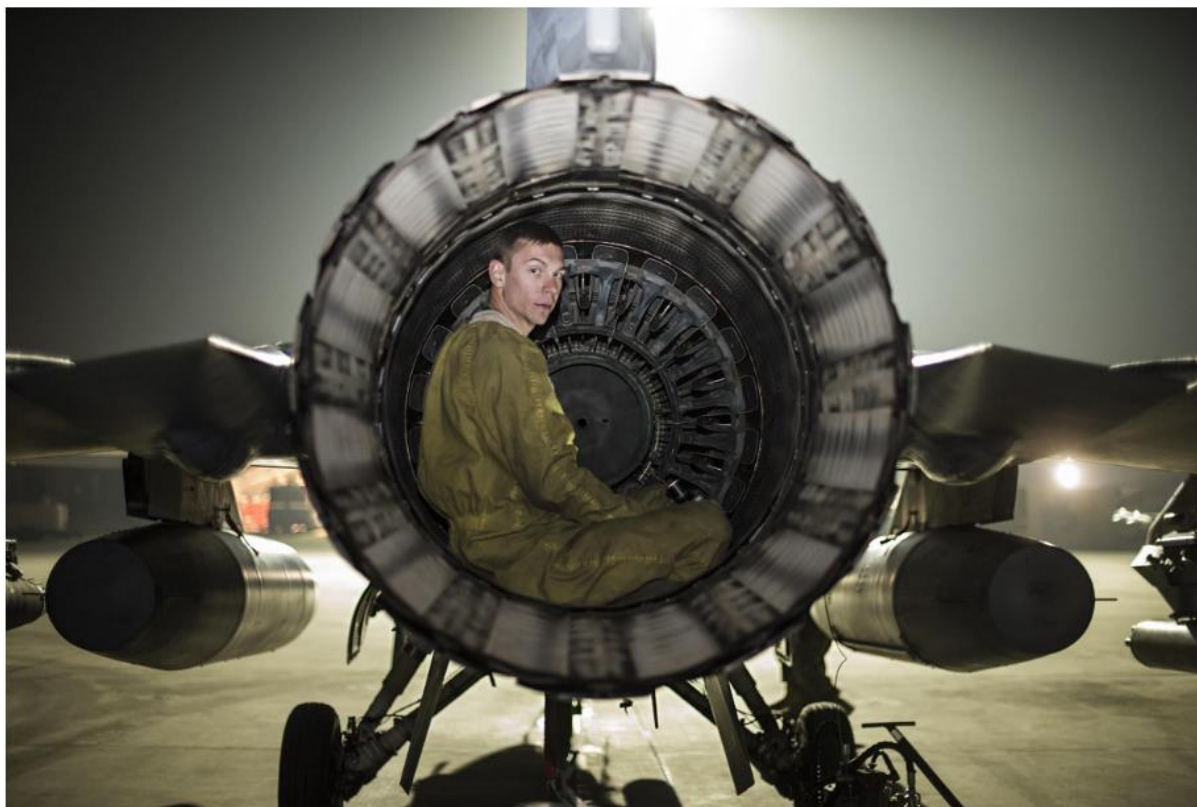
Εικόνα 9: Οπτικός Έλεγχος Αεροκινητήρα στην Μετά-Πτήσεως Επιθεώρηση
