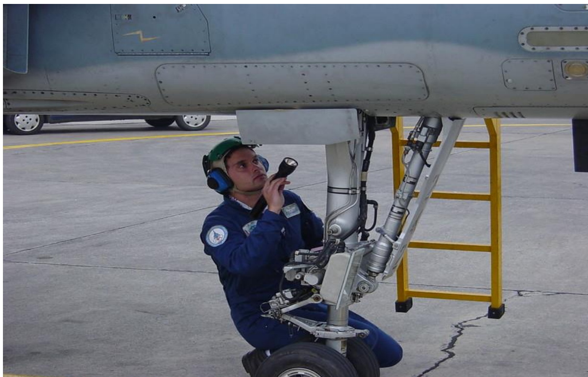
Εικόνα 8: Επιθεώρηση Συστήματος Προσγείωσης.
