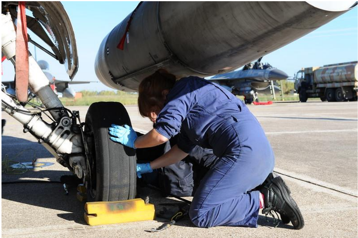
Εικόνα 4: Επιθεώρηση τροχού Α/Φ.
