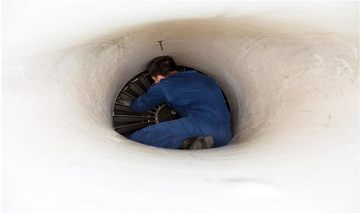
Εικόνα 5: Επιθεώρηση Πτερυγίων Αεροκινητήρα από Τεχνικό.
