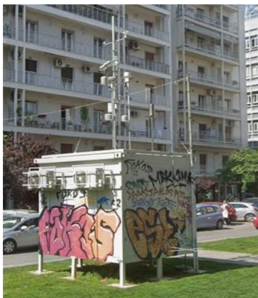
Εικόνα 2 Σταθμός Μέτρησης Ατμοσφαιρικής Ρύπανσης στην θέση Αγ. Σοφία (πηγή: Google maps)
