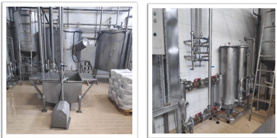
Εικόνα 4.12 Χώρος παρασκευής σιροπιού (δεξαμενές και φίλτρα)
