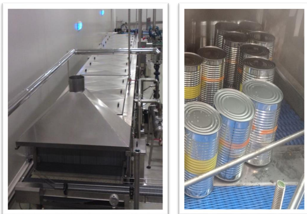
Εικόνα 4.14 Μονάδα αποστείρωσης- είσοδος σφραγισμένων περιεκτών
