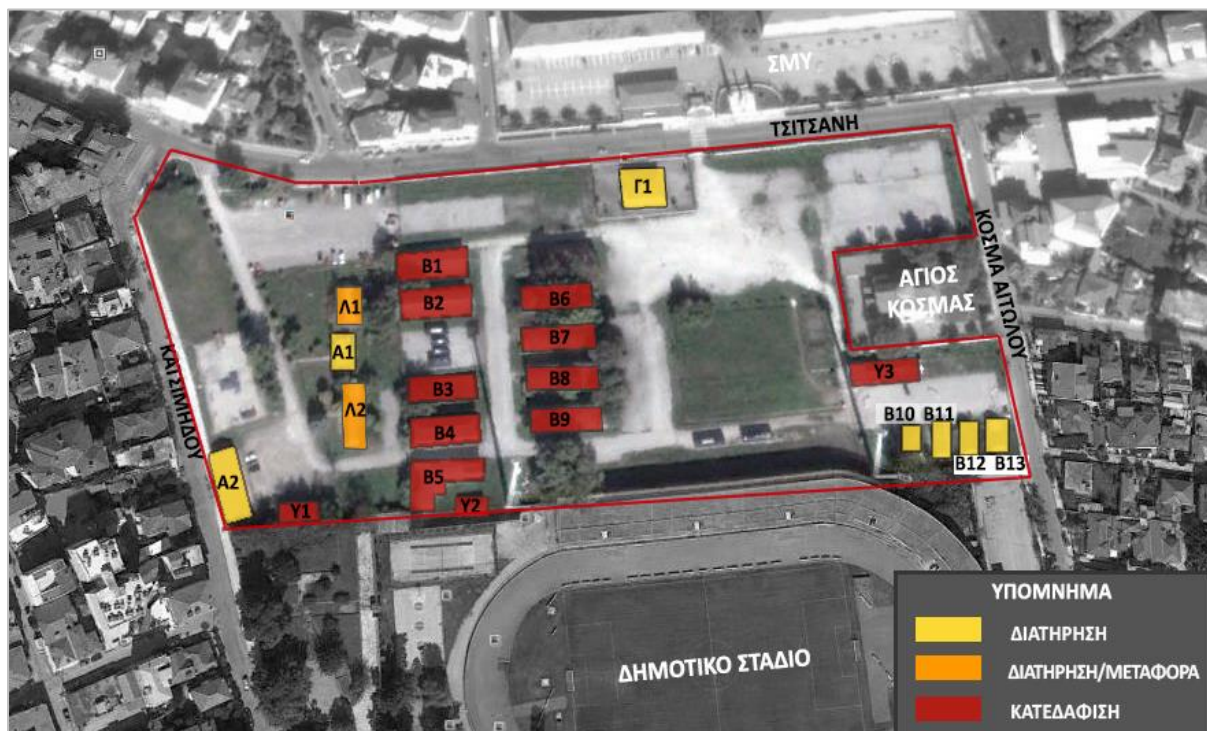
Εικόνα 6-5: Διάγραμμα προτεινόμενης διατήρησης/κατεδάφισης κτιριακού αποθέματος. Πηγή: google earth (ιδία επεξεργασία)
