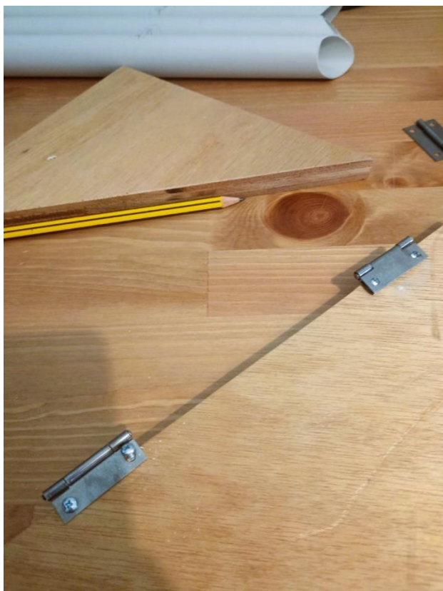
Εικόνα 98. Τοποθέτηση 2 μεντεσέδων σε κάθε τρίγωνο πάνελ.
