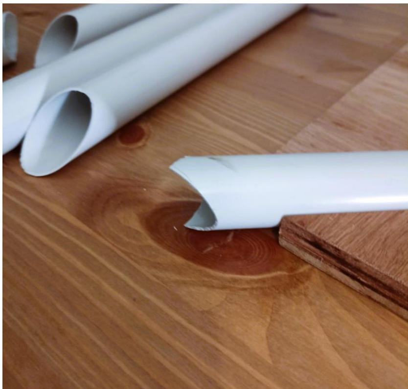
Εικόνα 97. Κοπή των ακμών του διαγώνιου σωλήνα PVC, που αποτελεί και τον άξονα κίνησης.
