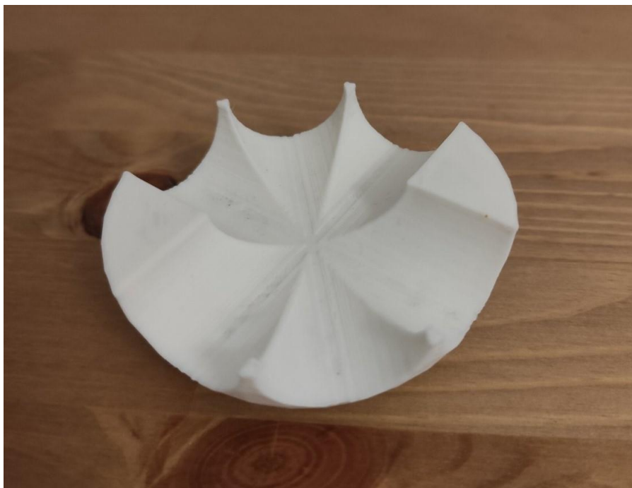
Εικόνα 130. Εκτύπωση βάσης με 3 ρίπες από σύνδεσμο σε τυχαία θέση
