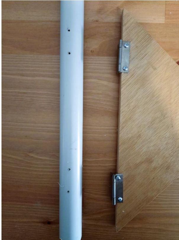
Εικόνα 99. Τρύπημα και βίδωμα των μεντεσέδων στον άξονα κίνησης – διαγώνιο PVC.
