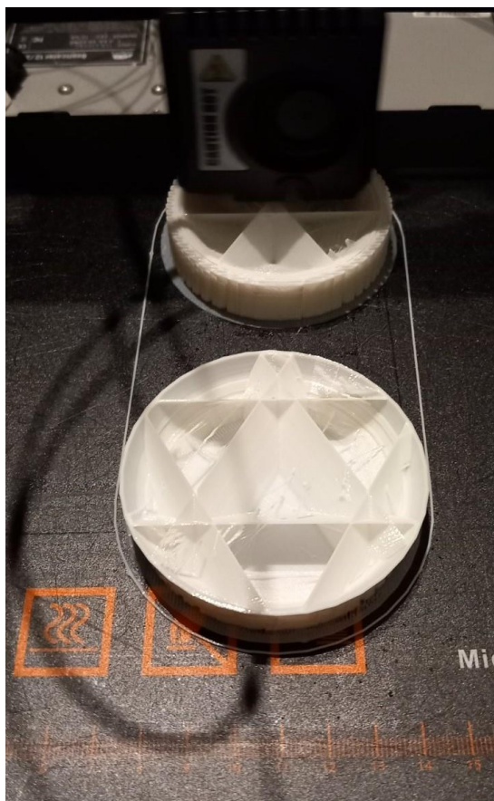
Εικόνα 126. Εκτύπωση 3d printing, βλέπουμε το infill.
