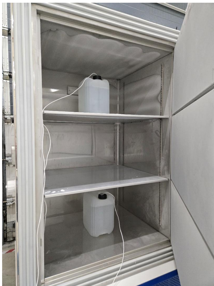
Εικόνα 3 Δοκιμή Πήξης 10 λίτρων μπουκαλιών γεμισμένα με νερό - Ερμητικός Συμπιεστής
