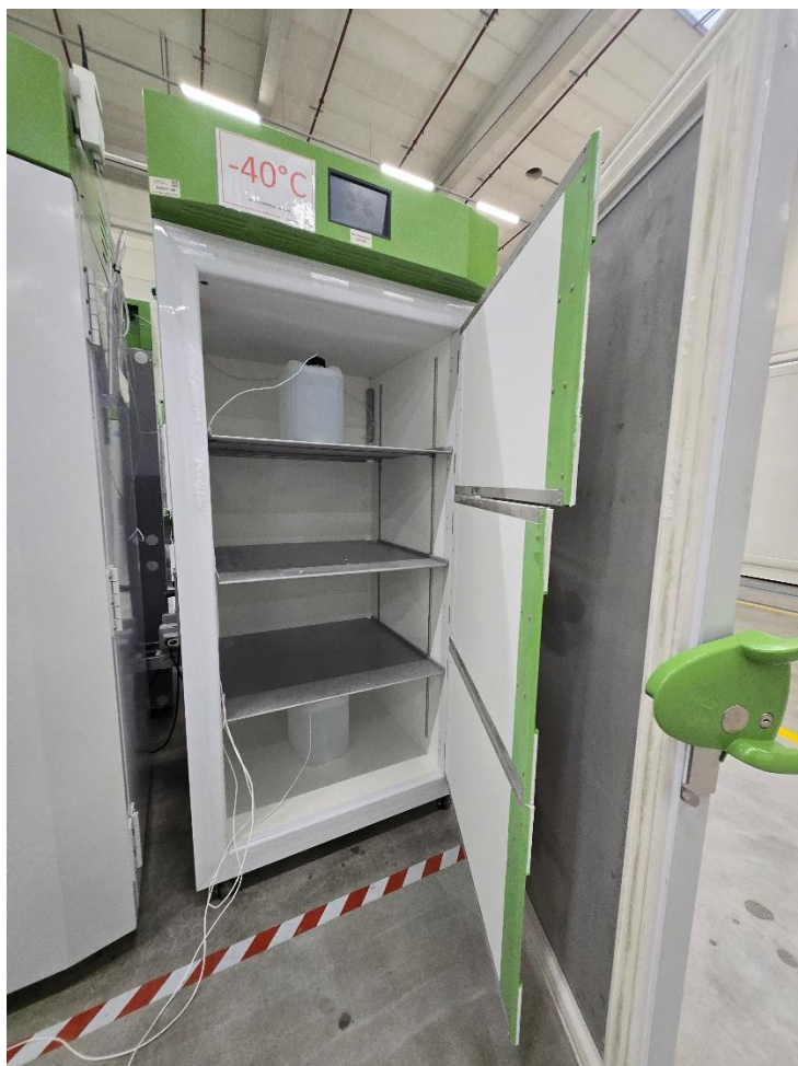
Εικόνα 4 Δοκιμή Πήξης 10 λίτρων μπουκαλιών γεμισμένα με νερό - Μηχανή Ελεύθερου Εμβόλου
