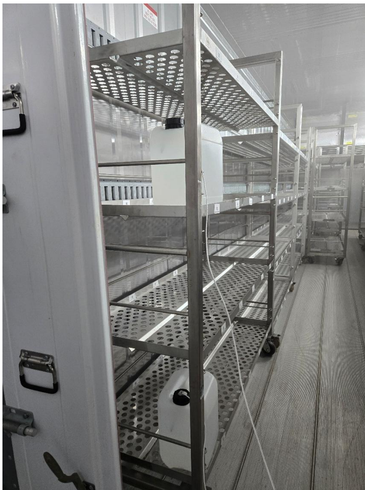
Εικόνα 5 Δοκιμή Πήξης 10 λίτρων μπουκαλιών γεμισμένα με νερό – Πολυσυμπιεστές
