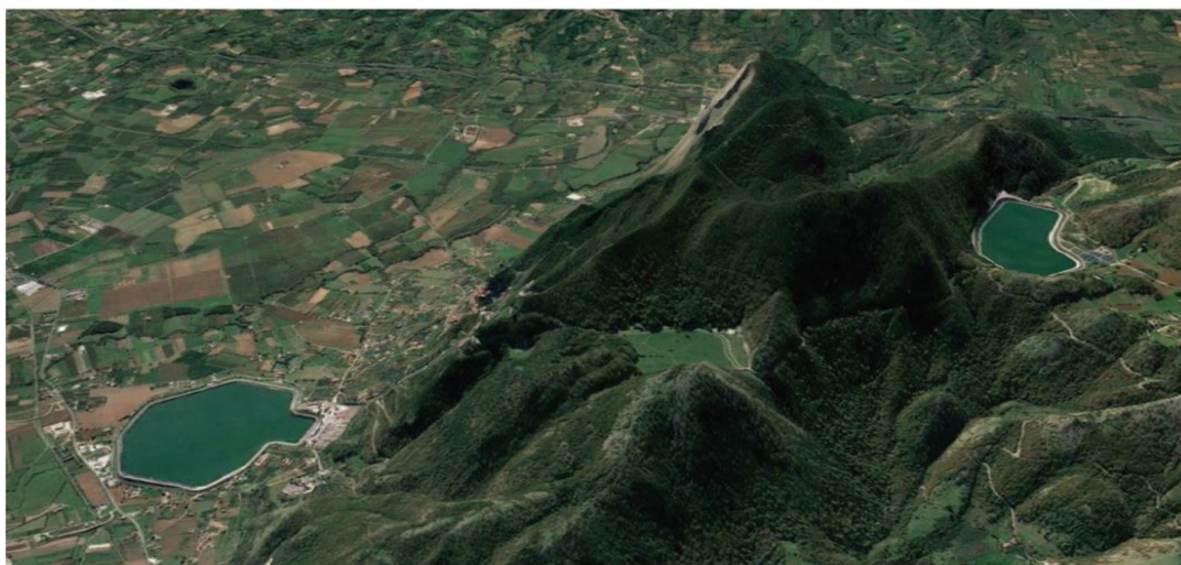
Σχήμα 6: Υδροηλεκτρικό εργοστάσιο Presenzano στην Ιταλία με τις δεξαμενές (άνω δεξιά και κάτω αριστερά). Αυτό το σύστημα αποθήκευσης με αντλία κλειστού βρόχου έχει κεφαλή 500 m, χωρητικότητα 1GW και αποθήκευση περίπου 6GWh [8]
