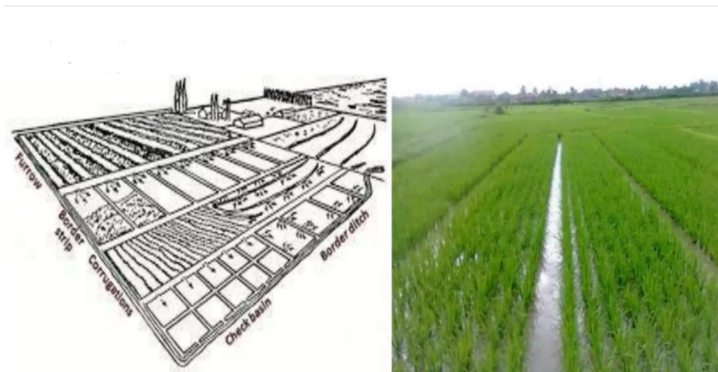
Εικόνα 6: Σύστημα άρδευσης με λωρίδες (Rahman, n.d.)
