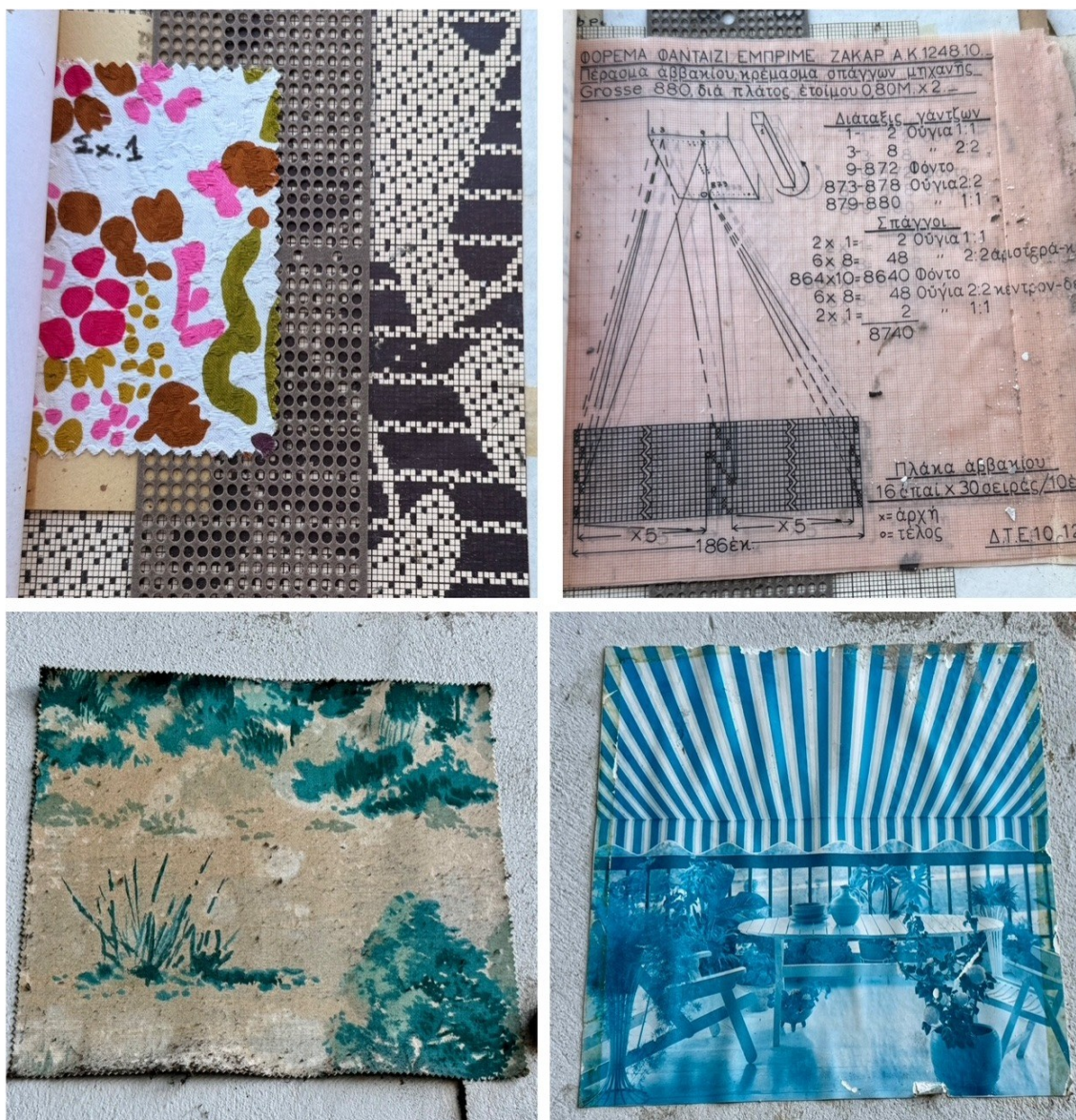
Εικόνα 1: Δείγματα τεντόπανων και σχέδια υφασμάτων με οδηγίες πως θα περάσουν από τα μηχανήματα, που υπάρχουν σήμερα στο χώρο του εργοστασίου (Φωτ. Βασιλική Δρακούλη, 13 Δεκεμβρίου 2025).
