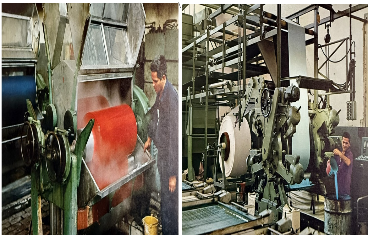
Εικόνα 3-5: Βαφική μηχανή υφασμάτων (δεξιά) και ταχυτυπωτική κυλινδρική μηχανή για υφάσματα με σχέδια (αριστερά). (Πηγή: Πειραική-Πατραϊκή, 50 χρόνια . Επιμέλεια Φρ. Φραντζισκάκης. Αθήνα: Ασπίωτη ΕΛΚΑ, 1969, 47, 49).
