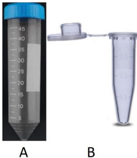
Εικόνα 34 Κωνικά σωληνάρια φυγοκέντρησης. Α) Τύπου Falcon Β) Τύπου Eppendorf.
