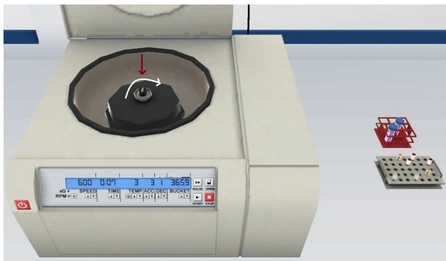
Εικόνα 42 OnLabs ΕΑΠ - Παρουσιάζεται ο τρόπος που ασφαλίζει το καπάκι στην κεφαλή (εικόνα από το OnLabs του ΕΑΠ).
