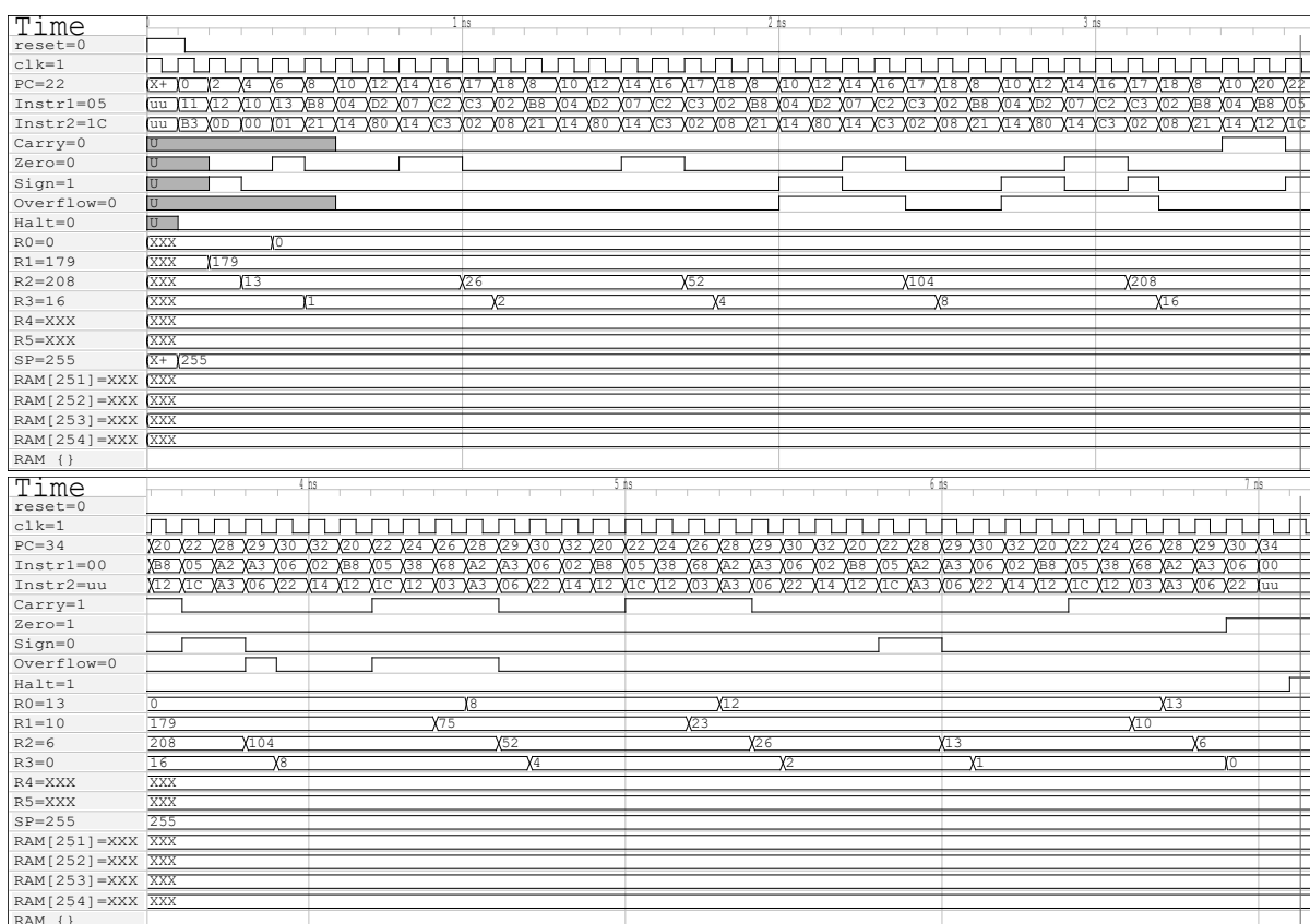
Εικόνα 63: Βελτιωμένος αλγόριθμος διαίρεσης “ανέβα-κατέβα”
