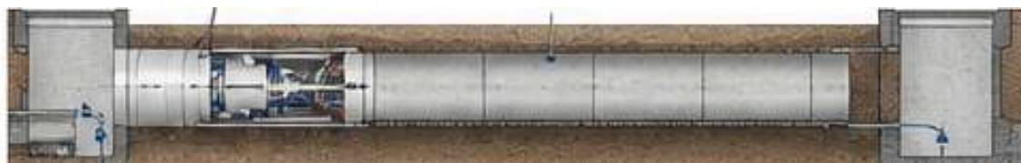
Εικόνα 6.4: Σχηματική απεικόνιση της λογικής μικροσήραγγας σε έργο
