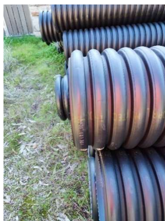
Εικόνα 5.1-5.2: Σωλήνες με λεία εσωτερική επιφάνεια και δομημένο εξωτερικό τοίχωμα
