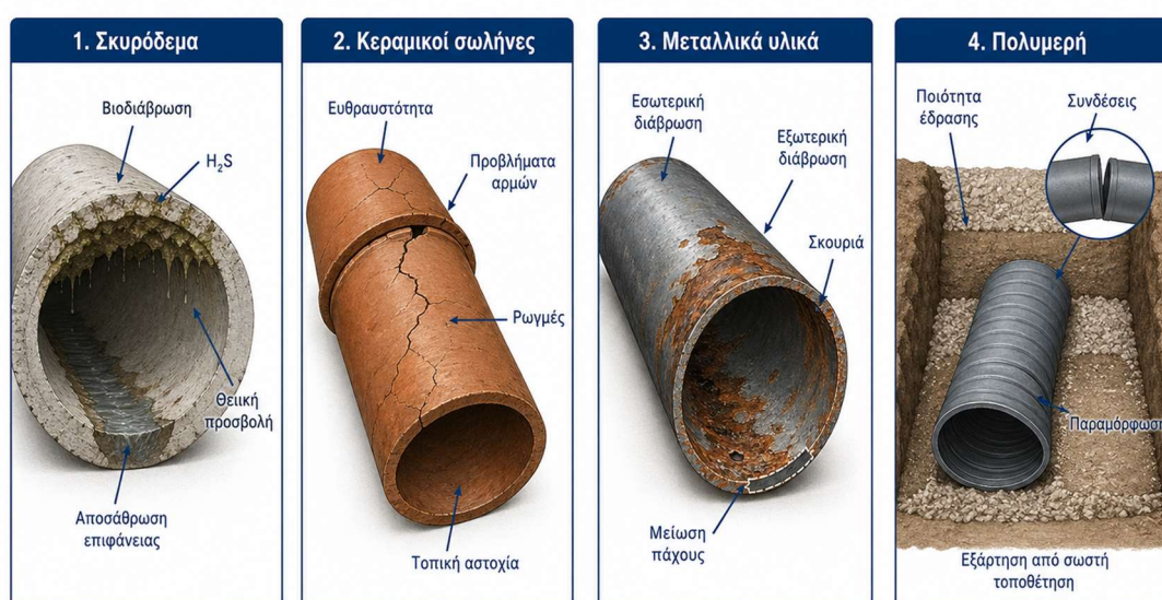
Σχήμα 5.1: Βασικοί μηχανισμοί φθοράς σε παραδοσιακά υλικά αγωγών αποχέτευσης
