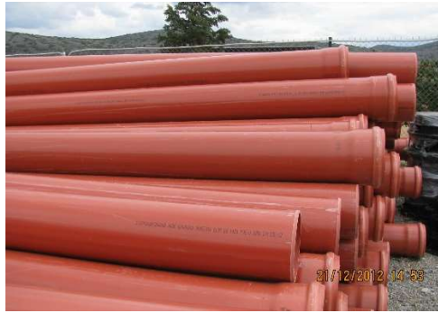
Εικόνα 2.1: Αγωγοί PVC-u σειρά 41 με χρήση στην αποχέτευση
