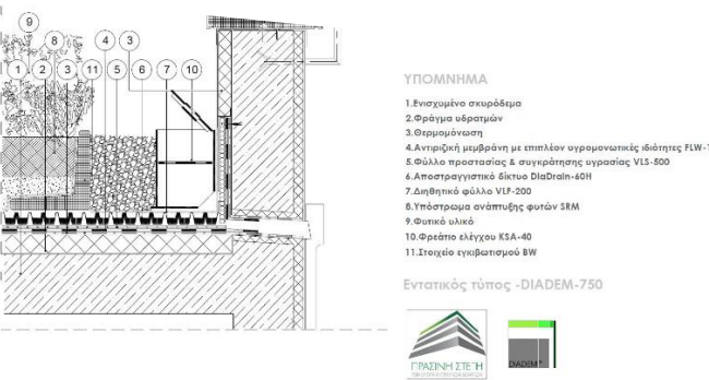
Εικόνα 3. Τομή φυτεμένου δώματος εντατικού τύπου ( πηγή : https://www.prasinistegi.gr/tupoi-futemenwn-dwmatwn/entatikos-tupos-diadem-750/ ).
